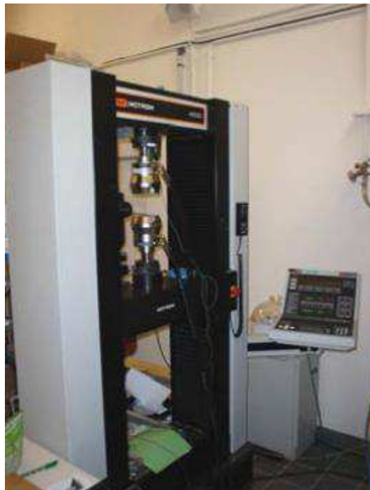
Figure II-7 : Machine de pré-endommagement des éprouvettes de Cerasep®A40C à température ambiante
