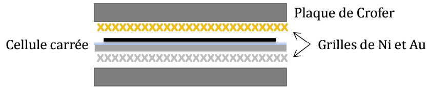
Figure 4-28. Distribution de gaz au travers des grilles collectrices de courant. Vue en coupe dans le sens de l'arrivée des gaz
