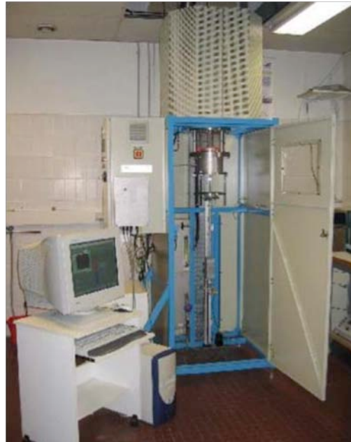
Figure II. 5 Four de cuisson automatisé à gradient vertical.
