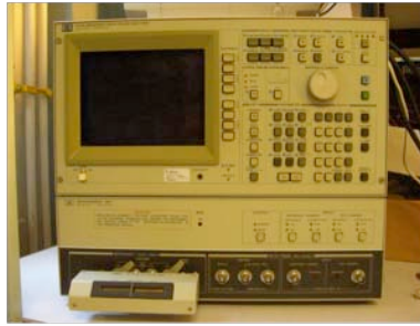
Figure II. 30 Impédancemètre HP4194A utilisé pour les mesures électriques.
