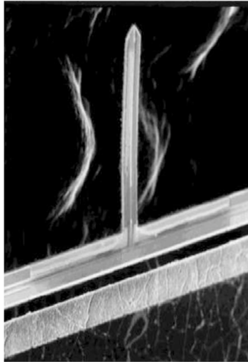
Figure I. 7 Micro Poutre AFM actionnée en XYZ à l'aide d'une couche mince piézoélectrique.
