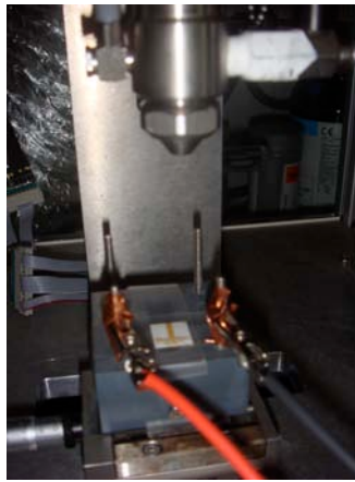
Figure III. 13 Analyse du déplacement de nos MEMS grâce au vibromètre MSA500 (Polytec).
