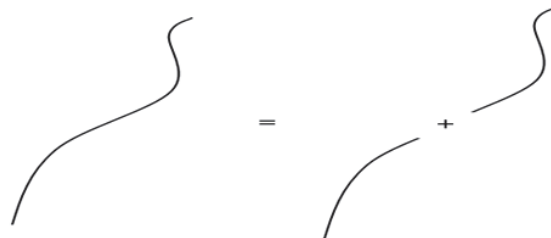
Figure 5.21 — Principe de continuité de courbure.
