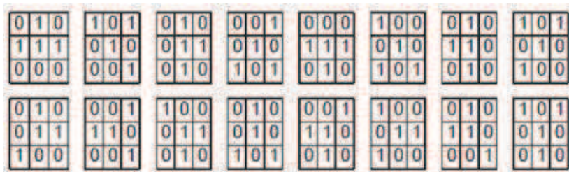
Figure 5.10 — ES pour les points de jonction : B et ses rotations (\theta_1(B), \theta_2(B), \dots, \theta_7(B)) dans la rangée supérieure; C et ses rotations (\theta_1(C), \theta_2(C), \dots, \theta_7(C)) dans la rangée inférieure
