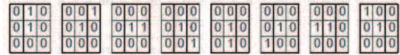
Figure 5.9 — ES (éléments structurants) pour les points terminaux : le A et ses rotations (\theta_1(A), \theta_2(A), \dots, \theta_7(A)) dans l'ordre
