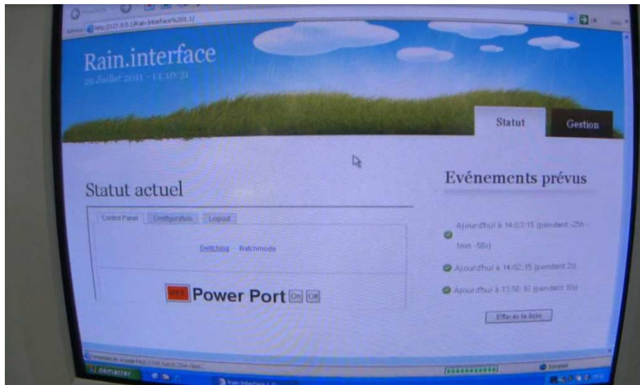
Figure 69 : interface utilisateur pour le pilotage du vérin via la prise programmable
