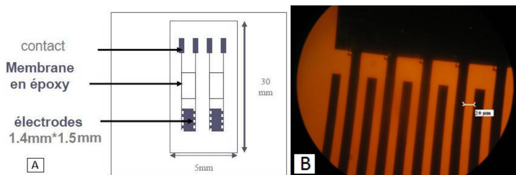
Figure 22 : schéma des électrodes interdigitées (Chouteau, 2004) (A) et zoom sur les interdigitations (B)
