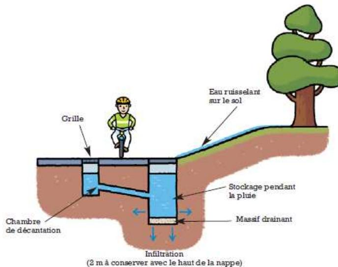
Figure 5: coupe d'une chaussée à structure réservoir (Grand-Lyon, 2008)
