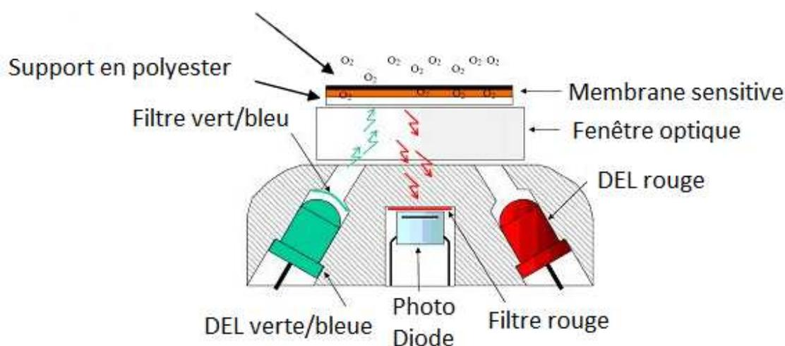
Figure 29 : fonctionnement d'une optode, d'après (Tengberg et al., 2006)
