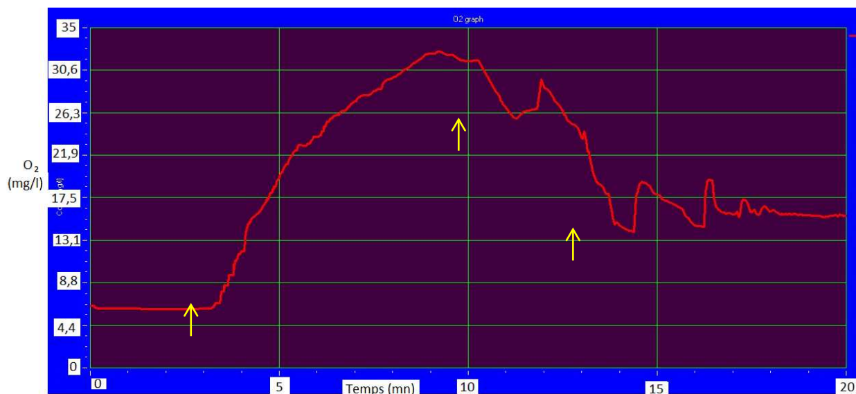
Figure 52 : [O_2] = f(t) après 3 injections successives de 0,5% d' H_2O_2 sur sol-gel
