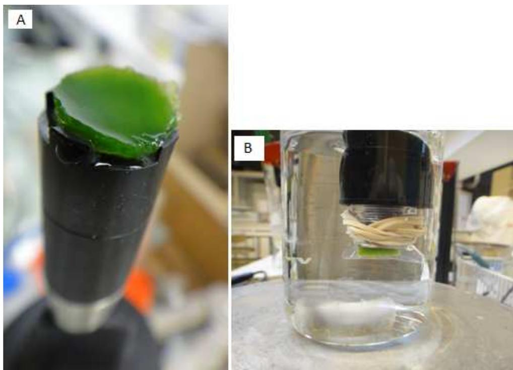
Figure 46 : gel d'agarose déposé sur l'électrode de Clark (A) et immobilisé sur une optode à l'aide d'une membrane de dialyse (B)
