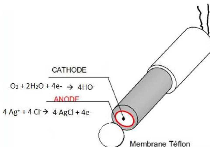
Figure 28 : fonctionnement d'une électrode de Clark
