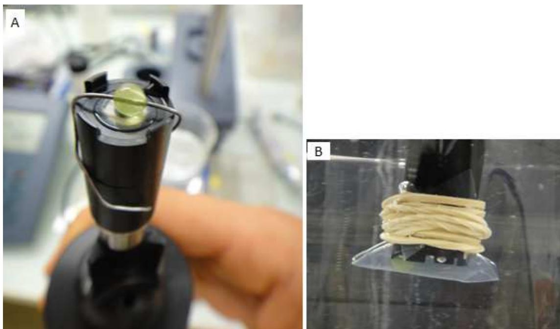
Figure 48 : bille d'alginate immobilisée sur un fil d'acier (A) et à l'aide d'une membrane de dialyse (B)
