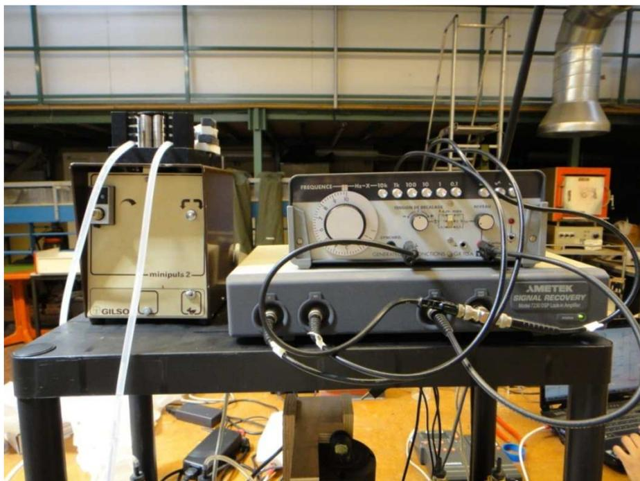
Figure 70 : le groupe acquisition (sur la droite) composé du *Lock-in*, d'un générateur de tension et d'un ordinateur (au second plan). On retrouve sur la gauche de cette photographie la pompe péristaltique du groupe hydraulique
