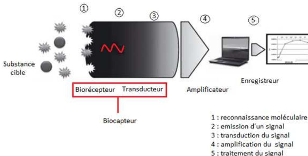
Figure 13 : représentation et fonctionnement schématique d'un biocapteur, adaptée de (Asch, 2010)
