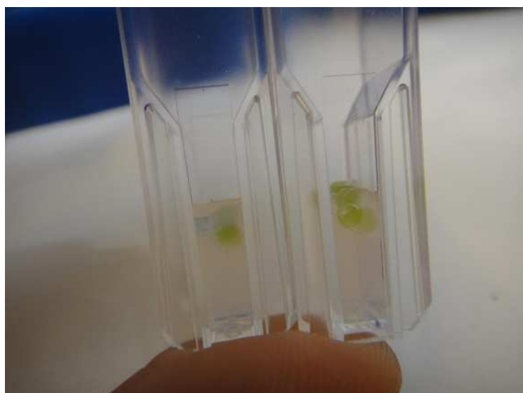
Figure 32 : billes d'alginate dans une matrice sol-gel
