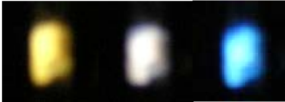
Figure V.1 : Luminescence d'une nano particule de ZnO observée à différentes longueurs d'onde
