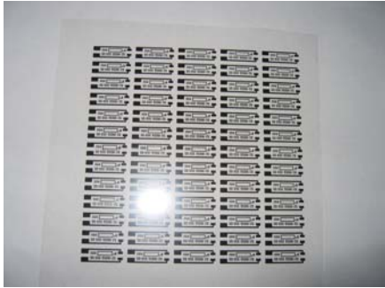
a) Typon pour substrats contacts AgPd sérigraphiés sur alumine (TFE)
