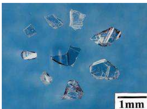
Figure 1.16 : images de cristaux de c-BN obtenue à haute pression (5.5 GPa) et 1600°C avec un flux assisté de BaBN [61].
