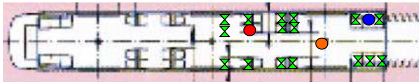
Figure 3-12 Position des émetteurs GSM/UMTS dans la rame de métro.
