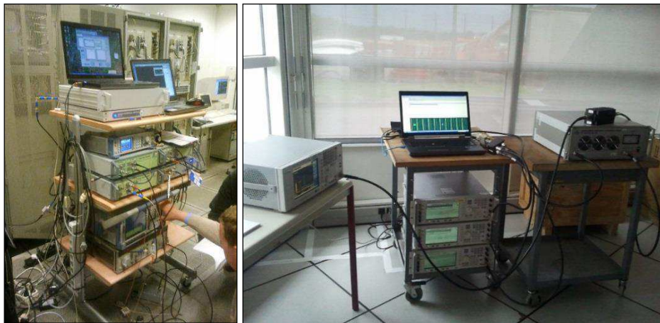
Figure 2-19 Systèmes de mesure et de génération des brouilleurs WIMAX et LTE permettant de couvrir la bande complète en TDD et FDD.
