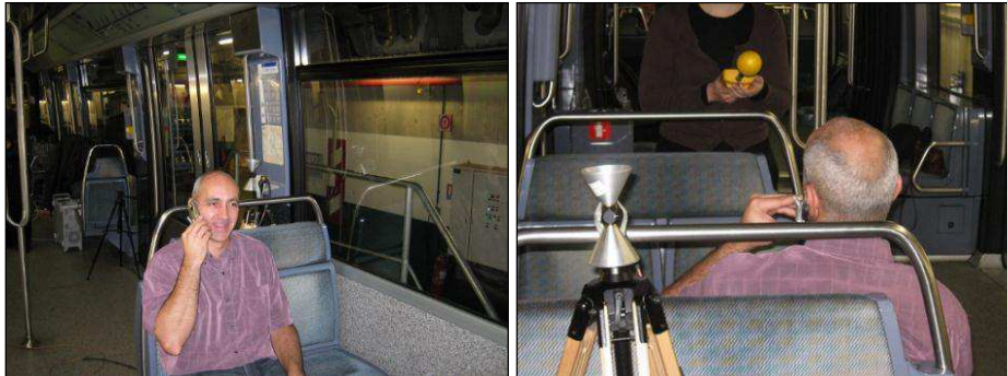
Figure 3-13 Mesures de champ réalisées dans une rame de métro avec ou sans la présence de personnes.
