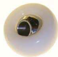
Figure 9: Exemple de couple de frottement métal/UHMWPE [39]
