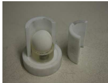
Figure 45: Photo d'une sphère dans son bloc de résine avant usinage
