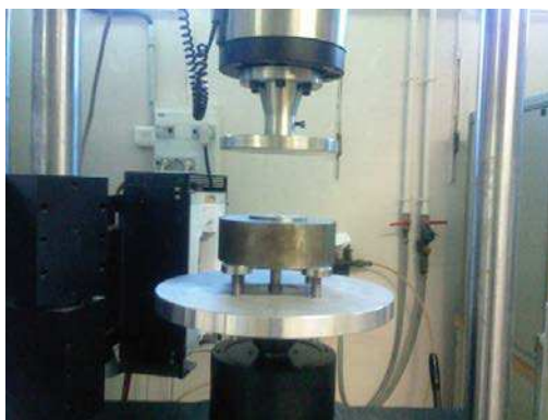
Figure 29: Matrice de compression et pistons montés sur la presse INSTRON
