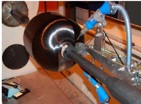
*Figure 2 : Bobinage de la structure composite d'un démonstrateur [1]*
