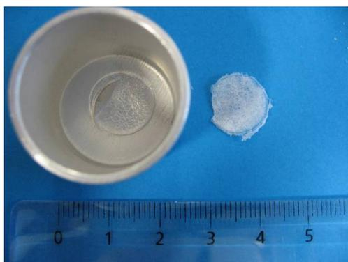
*Figure III-25 : Correspondance géométrique entre les résidus de type b et la zone d'impact de la coupelle LOX*
