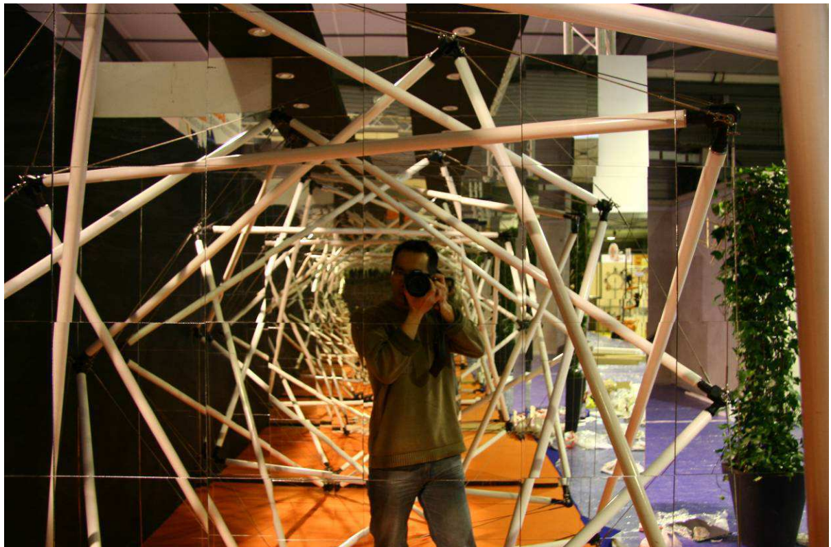
Vue d'un d'anneau de tensegrité entre deux plans équipés de miroirs
