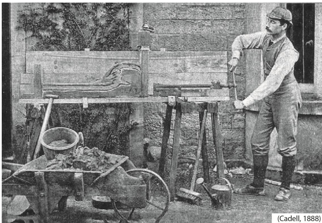
Fig 1.2. Modelo realizado por Cadell 1888, para investigar la formación de los pliegues (Tomado de Graveleau et al., 2012).
