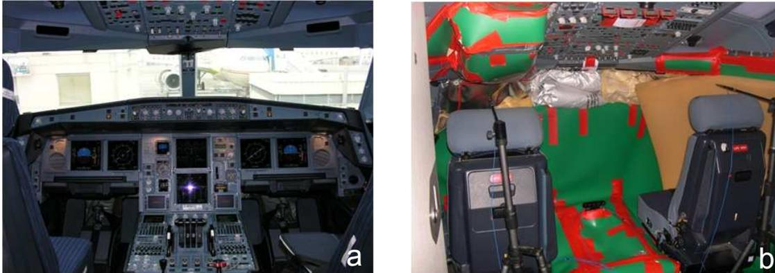
FIGURE 3 – a. Cockpit standard - b. Cockpit d'A340 en cours d'aménagement pour la mesure de puissance acoustique au sol
