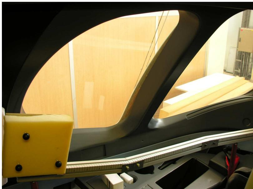
FIGURE C.2 – Objet suivi et positionnement des trois sphères repérées par les caméras lors du déplacement
