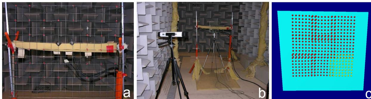
FIGURE 2.2 – a. Dispositif d'essais avec deux sources en champ libre - b. Vue globale avec la caméra - c. Visualisation des 9 patches de mesure
