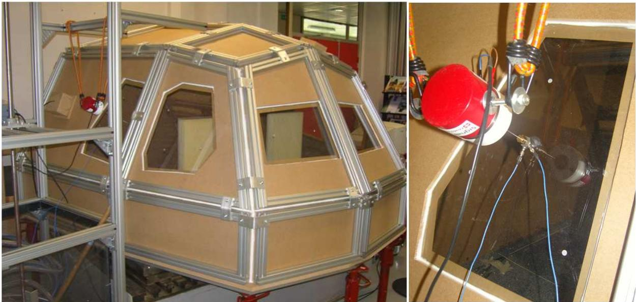
FIGURE 5.8 – Pot vibrant excitant la vitre arrière droite de la maquette
