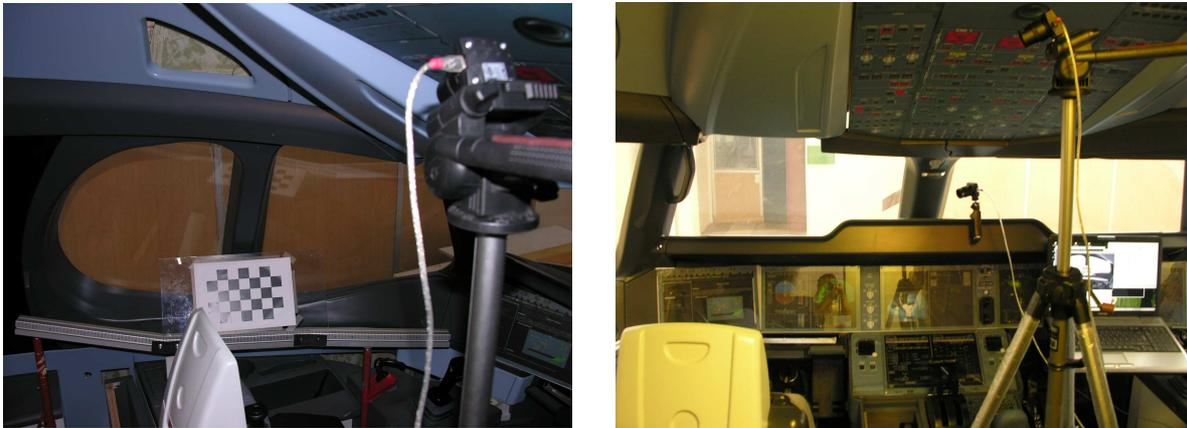
FIGURE C.1 – Photographies de l'emplacement des caméras dans la maquette et de l'étape de calibration
