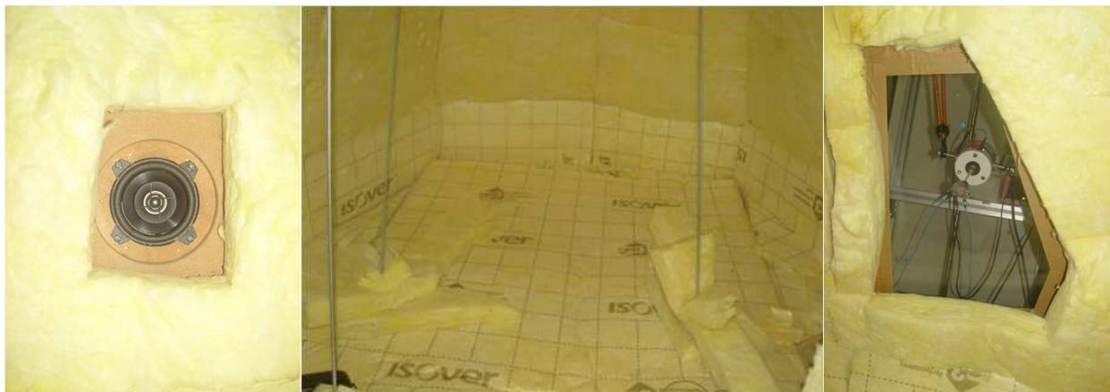
FIGURE 5.9 – Habillage de la maquette de laine de verre pour la calibration des sources
