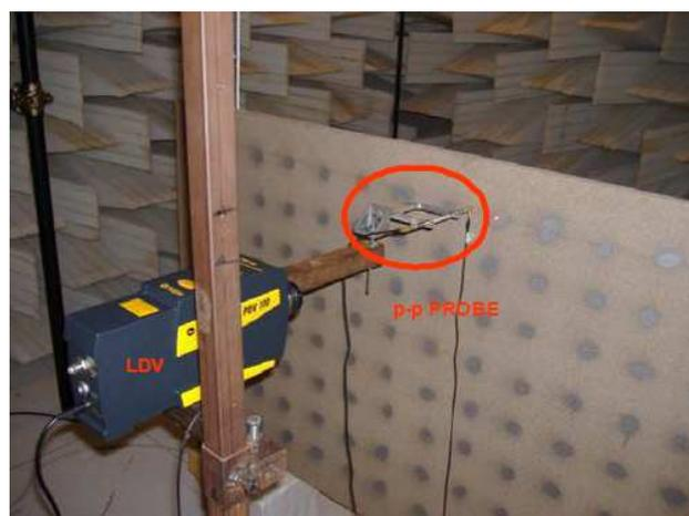
FIGURE 1.4 – Dispositif de mesure de l'intensité cohérente
