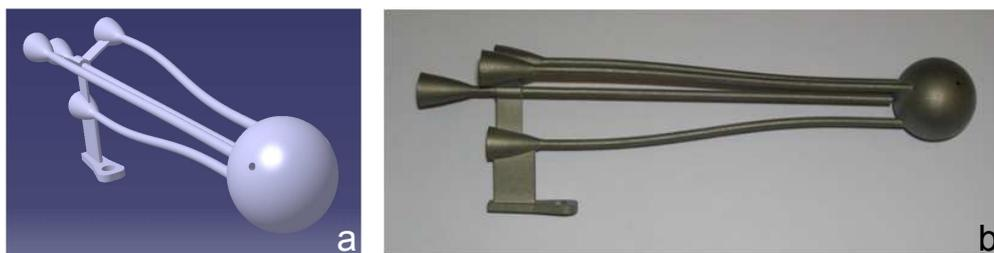
FIGURE 4.39 – CAO de la sonde sous Catia et vue de la sonde fabriquée
