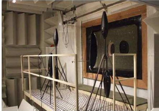
FIGURE 2.18 – Dispositif de mesure mis en place dans la chambre anéchoïque de Dassault afin d'extraire la puissance rayonnée par une surface à l'aide de la DLA pendant le projet CREDO
