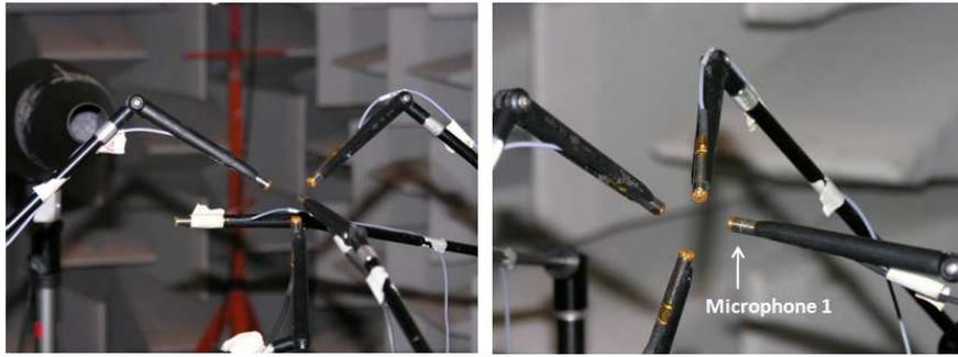
FIGURE 4.2 – Photographies du montage d'essais et zoom sur la sonde tétraédrique creuse réalisée
