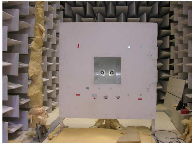
FIGURE 2.9 – Montage d'essais correspondant aux deux sources bafflées sur un panneau
