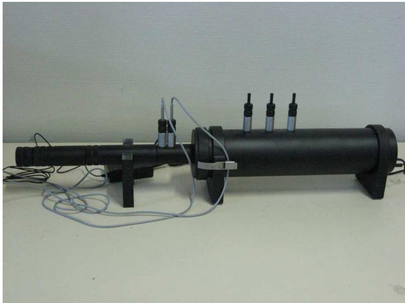
FIGURE D.1 – Photographie du tube de kundt utilisé pour la mesure du coefficient d'absorption des différents matériaux de la maquette
