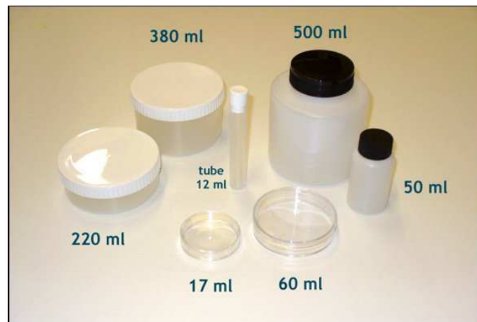
FIGURE 2.7 – Différentes géométries de conditionnement utilisées en spectrométrie \gamma .
