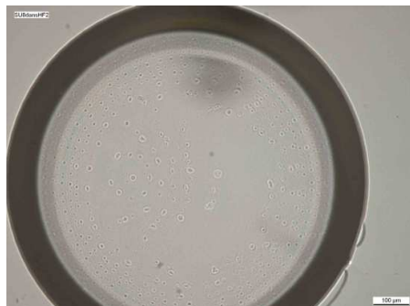
Figure 110. Résine SU8 non réticulée après l'attaque du cuivre et du titane
