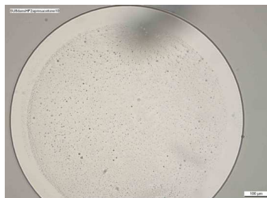
Figure 111. Après développement de la résine SU8 non réticulée ayant subi une métallisation Ti/Cu et deux attaques chimique, une du cuivre, l'autre du titane.
