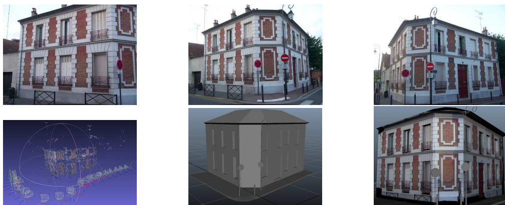
FIGURE 2.2 – Haut : une partie des images utilisées pour la reconstruction photo-réaliste. Bas : la calibration externe, la photo-modélisation et la restitution visuelle.
