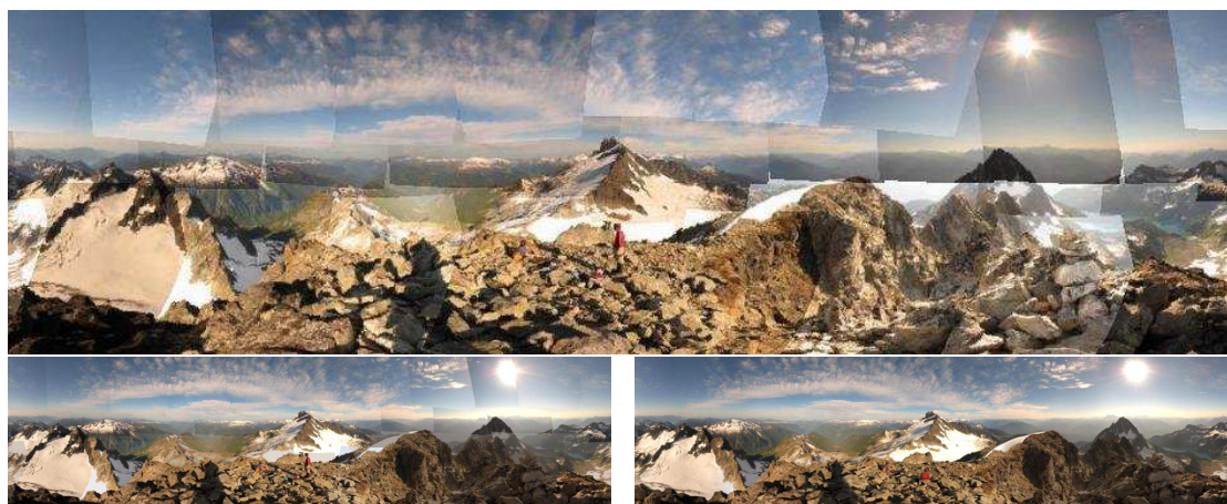
FIGURE 7.7 – En haut la mosaïque d’images d’origine, en bas à gauche l’ajustement de gain et en bas à droite le résultat du mélange fréquentiel (BROWN et LOWE 2007).
