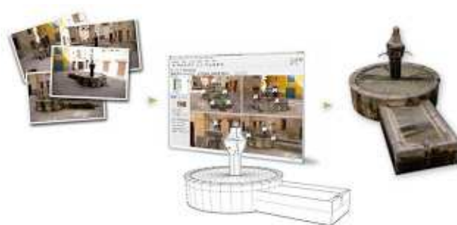
FIGURE 1.6 – ImageModeler : De gauche à droite, les images sources, les points et la géométrie saisies manuellement, la restitution colorée.
