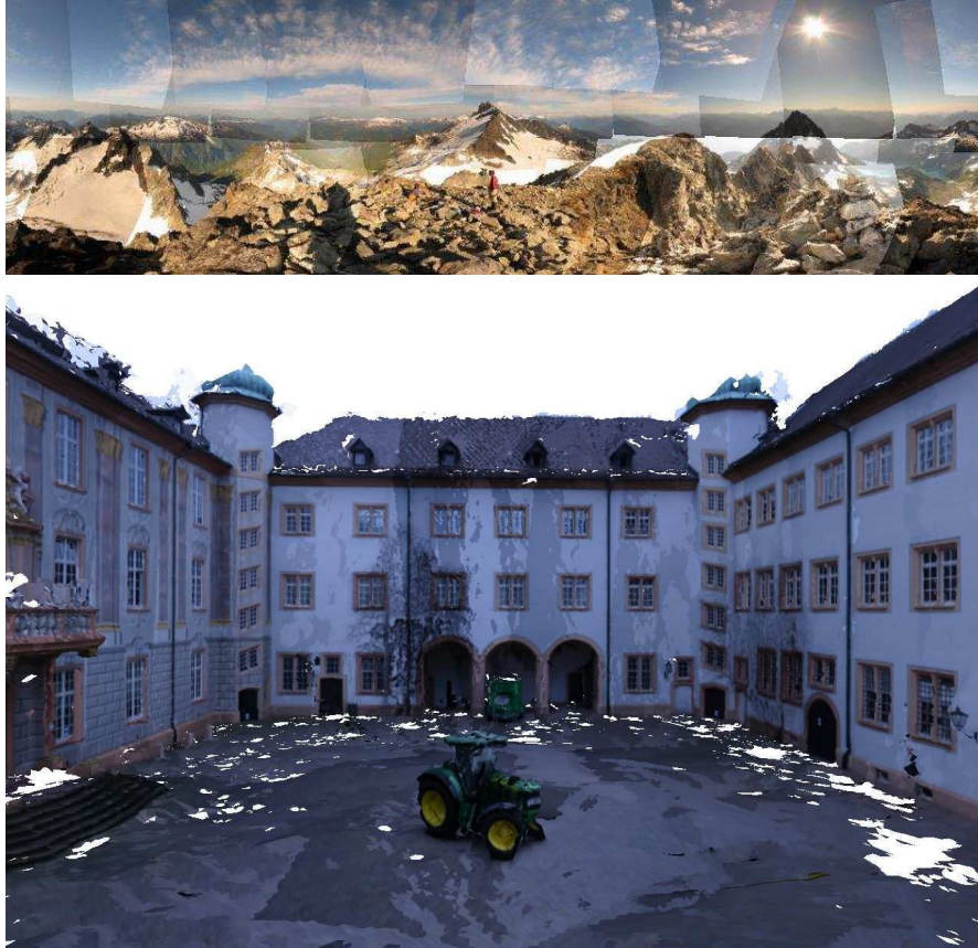
FIGURE 7.3 – Illustration de la problématique de la consistance colorée pour la construction d’images panoramiques (BROWN et LOWE 2007) et le cas de la restitution de l’apparence visuelle d’un maillage 3D (ALLENE et al. 2008).
