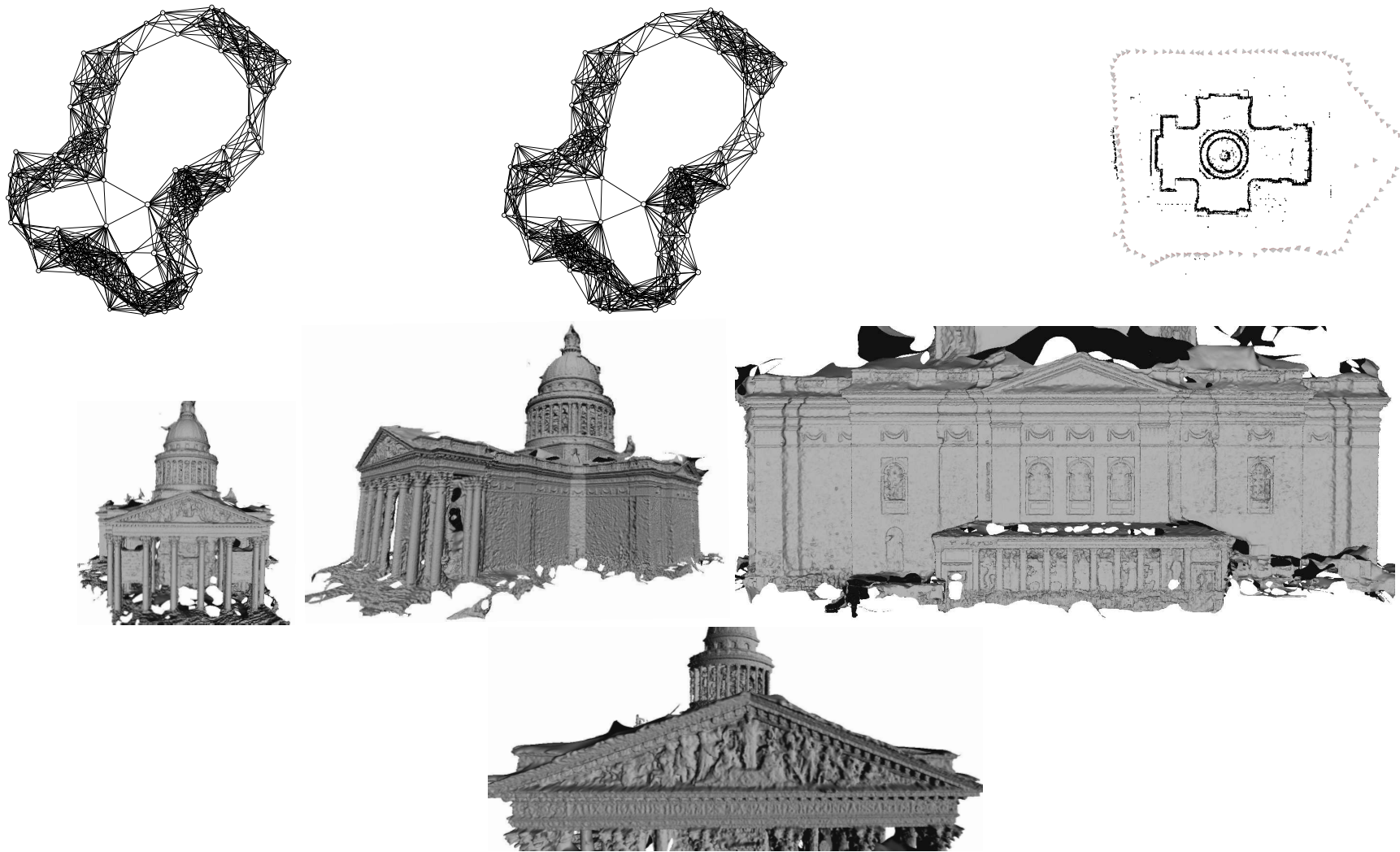
FIGURE 6.21 – PanthéonP126. En haut , de gauche à droite : le graphe épipolaire ( G_E ) avant puis après inférence ( G_R ). La structure et poses des caméras obtenues après calibration externe. En bas : des images du maillage reconstruit à partir de notre calibration externe du Panthéon de Paris.
