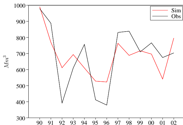
FIGURE A.13 – Volume de dotation annuel reconstitué (courbe noire) et simulé à SP (courbe rouge) sur la période 1990-2002
