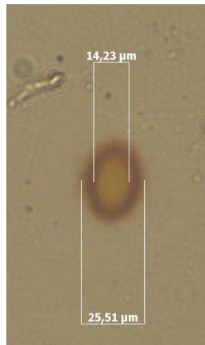
Figure 86: image optique d'un spot insolé pendant 300 \mu s avec une puissance de 130 mW.
