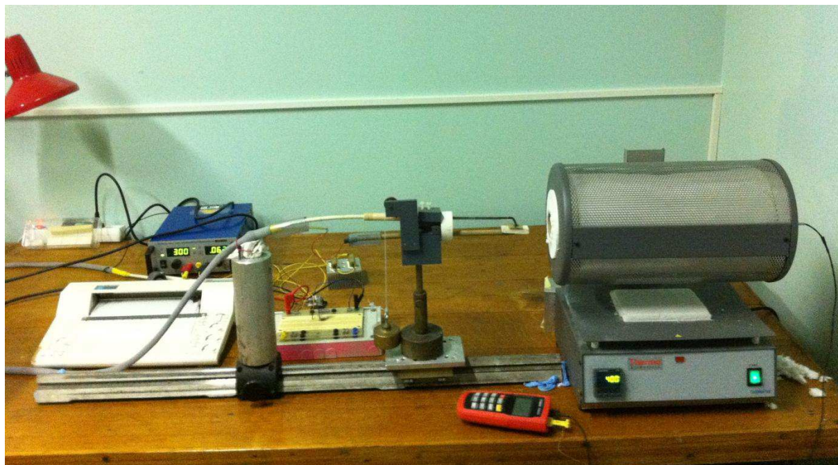
Figure 30 : photo du dispositif expérimental pour la réalisation du poling thermique.
