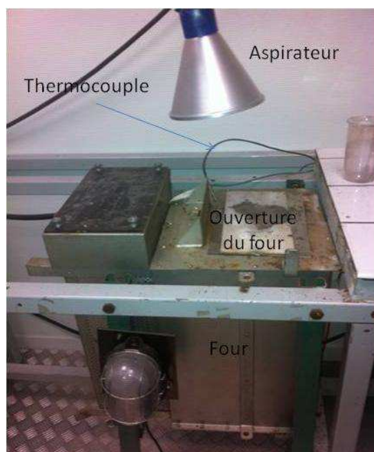
Figure 29 : photographie du four utilisé pour l'échange ionique.
