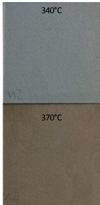
Figure 49: influence de la température de l'échange sur la coloration du verre. Les échantillons photographiés ont été échangés pendant 15 min.
