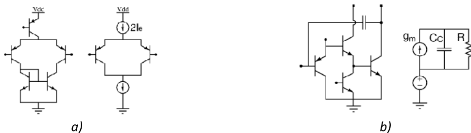
Figure II 1 Exemple de simplification différentiel du micro-modèle au macro-modèle. a) Paire différentielle utilisant la technique de simplification en remplaçant certains éléments par des sources de courant. b) Etage de gain idéalisé par des sources de tension commandées [Boulghassoul 03].
