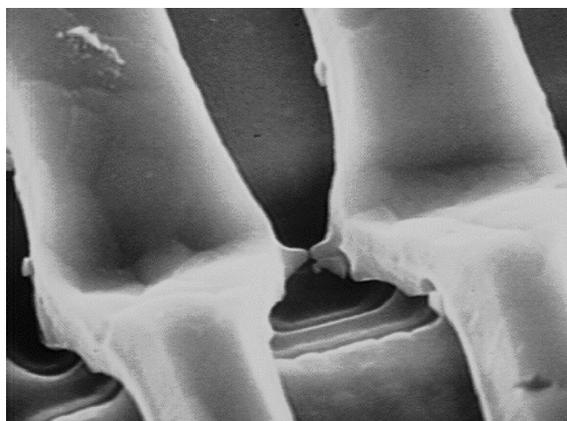
*Figure 69 : Défaut de type « SHORT » entre deux lignes métalliques.*
