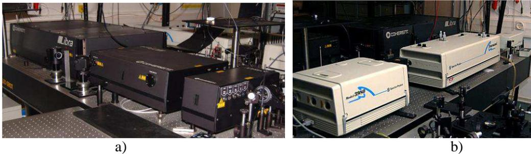
Figure II.1 : Principales chaînes laser de la plateforme ATLAS a) Chaîne laser femtoseconde "LIBRA+OPERA" b) Chaîne laser picoseconde laser "Tsunami".
