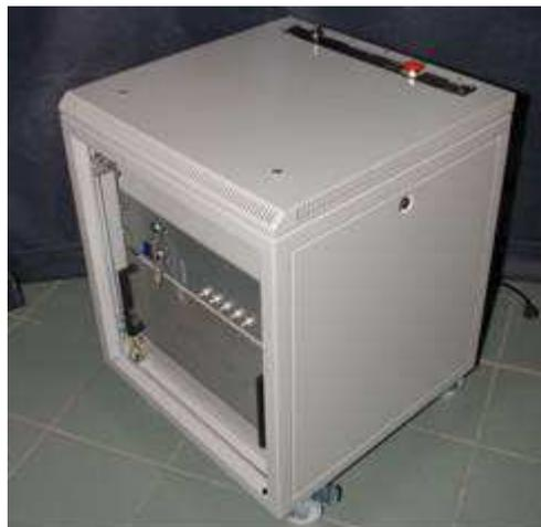
Figure IV-2 : Baie contenant le module laser picoseconde.
