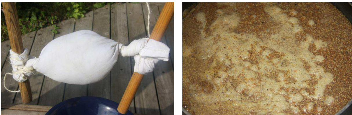
Figure 97 : Essai d'extraction d'huile par torsion (à gauche) et bouillon de graines de caméline (à droite)
