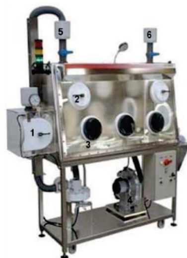
Figure 92 Boîte à gants faisant office de chambre de test d'un volume de 0,8 m 3 équipée : d'un double SAS (1), de hublots équipée de gants (2 et 3) ; d'un système de dépressurisation (4) et d'un filtre HEPA (5) ; ainsi que d'un système de repressurisation également équipé d'un filtre HEPA (6)
