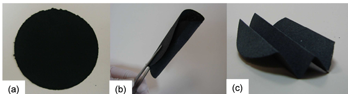
Figure II. 2 Cathodes \text{LiFePO}_4/\text{CB}/\text{FBs} . (a) plat, (b) enroulé et (c) plié.
