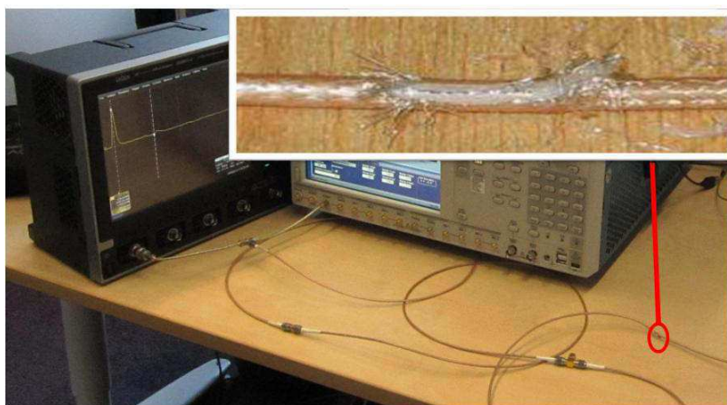
Figure IV.31 – Photo de l'expérience avec tous les appareils utilisés. A droite on trouve un générateur arbitraire des signaux AWG (Arbitrary Waveform Generator 7122C 24GS/s) et un Oscilloscope (Lecroy Waverunner 204Mxi 10GS/s) à gauche. Un câble SMA défectueux est aussi présent dans cette figure.
