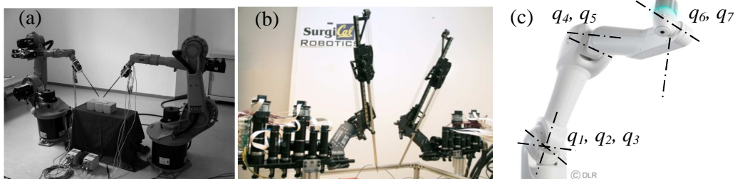
Figure 1-35: 2 robots à 8 ddls [Mayer et al. 2005] (a), robot Raven à 7 ddls [Rosen et al. 2011] (b), robot Miro à 7 ddls [Hagn et al. 2009] (c)
