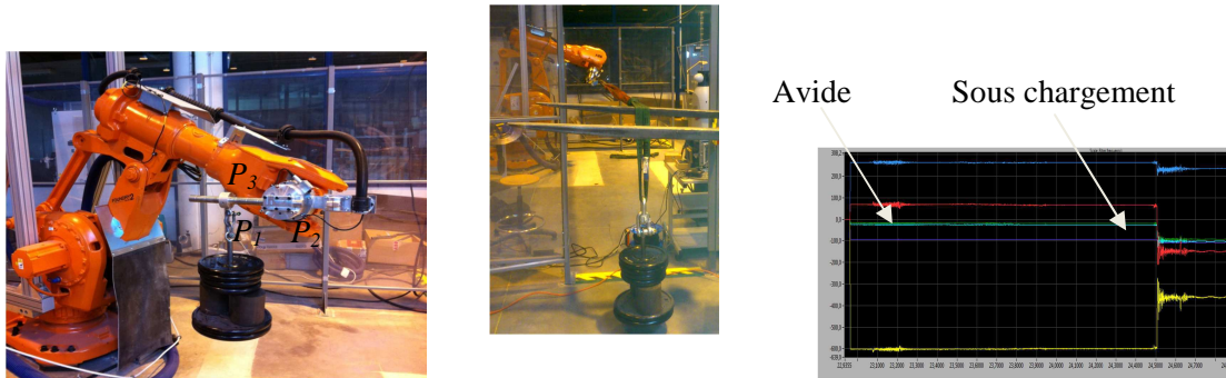
Figure A3-1 : Position des mires et sollicitation des liaisons 2 à 6 avec une charge de 1100N (a), sollicitation de la liaison 1 (b), enregistrement des d'efforts (c)
