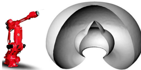
Figure 1-14 : Représentation tridimensionnelle de l'espace de travail maximal d'un robot sériel [Castelli et al. 2008].
