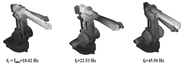
Figure 1-23: Analyse numérique des modes vibratoires d'un manipulateur [Karagulle et al. 2012]
