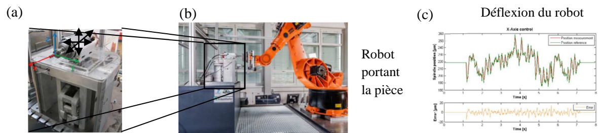
Figure 1-45 : Système piézo à 3 ddls portant la broche (a), cellule d'usinage (b), déplacement de la broche suivant l'axe X et erreurs de précision obtenues (c)
