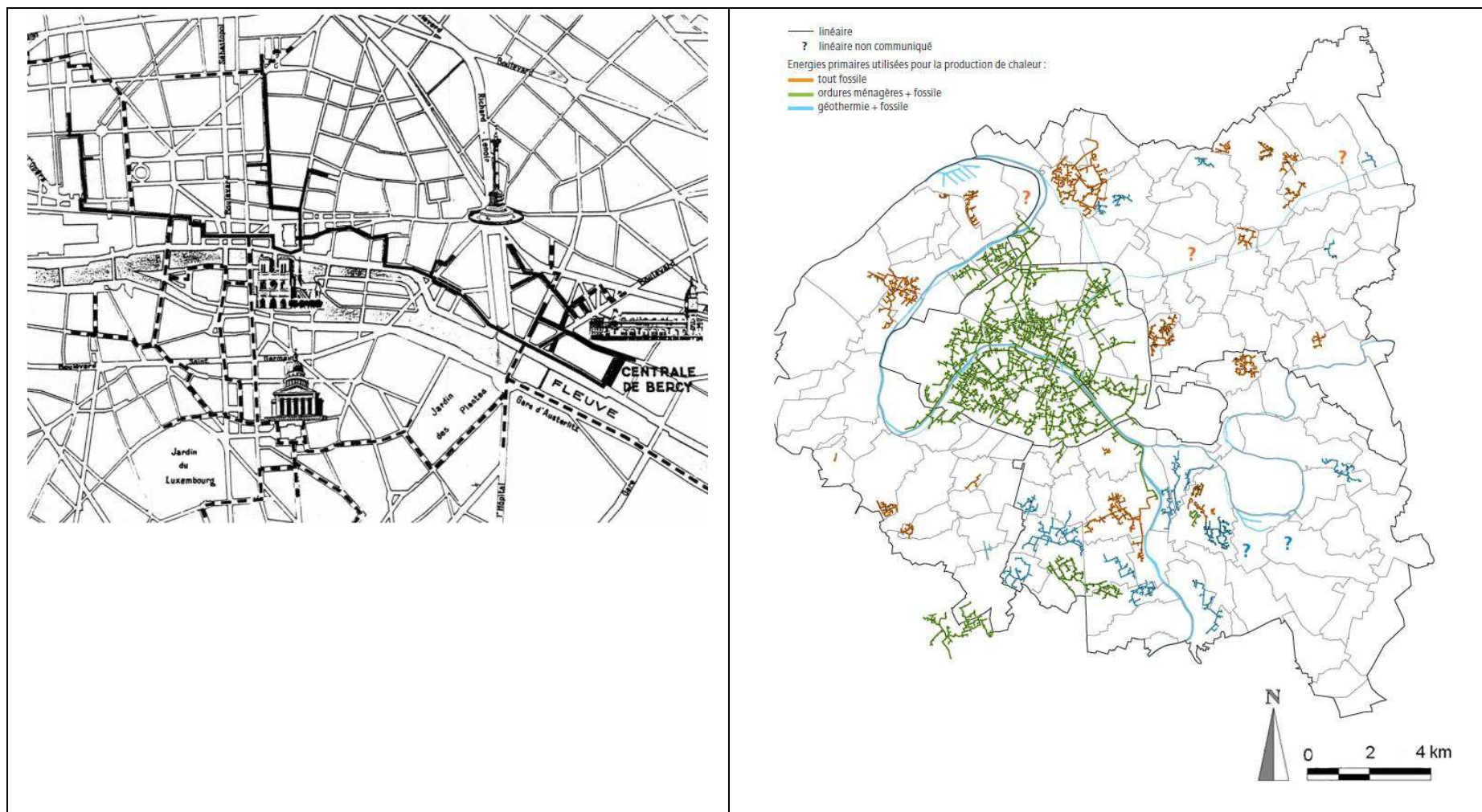
Figure 4.1.4. Plan du réseau et des usines de la CPCU en 1937 (gauche) et Plan de réseaux de chauffage urbain à Paris et en petite couronne en 2000-2001 (droite). Source : CPCU, 1937. Plan du réseau de la CPCU en 1937, 56 p., Li276/pl, cité par : Gallo, 2006, vol. II., p. 328. ; APUR, 2006, p. 6.
