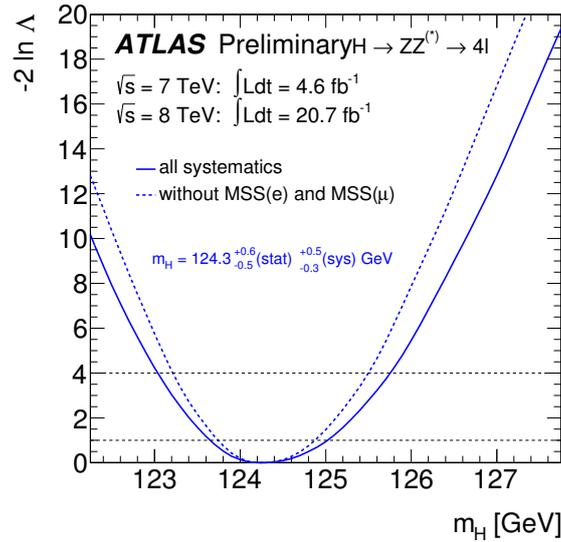
FIGURE 4.15 – Vraisemblance profilée en fonction de  $m_H$  pour la combinaison des données de 2011 et 2012. La vraisemblance profilée est montrée avec (courbe pleine) les systématiques sur l'échelle de masse des électrons ( $MSS(e)$ ) et des muons ( $MSS(\mu)$ ) et sans (courbe hachurée). L'incertitude avec 68% CL est déterminée par le point où la courbe de la vraisemblance profilée coupe 1.
