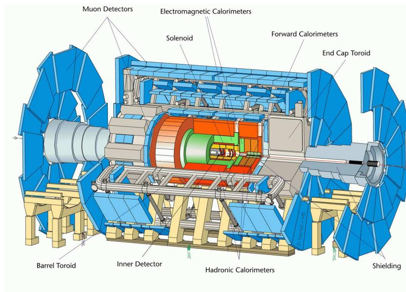
FIGURE 3.4 – Vue d'ensemble du détecteur. De l'intérieur vers l'extérieur, on trouve un détecteur interne plongé dans un champ magnétique solénoïdal, un calorimètre électromagnétique, un calorimètre hadronique, et un spectromètre à muons avec un système magnétique.
