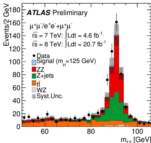
FIGURE 4.3 – Distribution de la masse invariante de la paire dominante  $m_{12}$  dans la région de contrôle définie par un boson  $Z$  standard et une paire secondaire de muons pour  $\sqrt{s} = 8$  TeV et  $\sqrt{s} = 7$  TeV. Les conditions d'isolation et de paramètre d'impact ne sont appliquées que sur la paire dominante qui compose le  $Z$ . Les MC sont normalisés par les estimations de bruit de fond dérivées des données.
