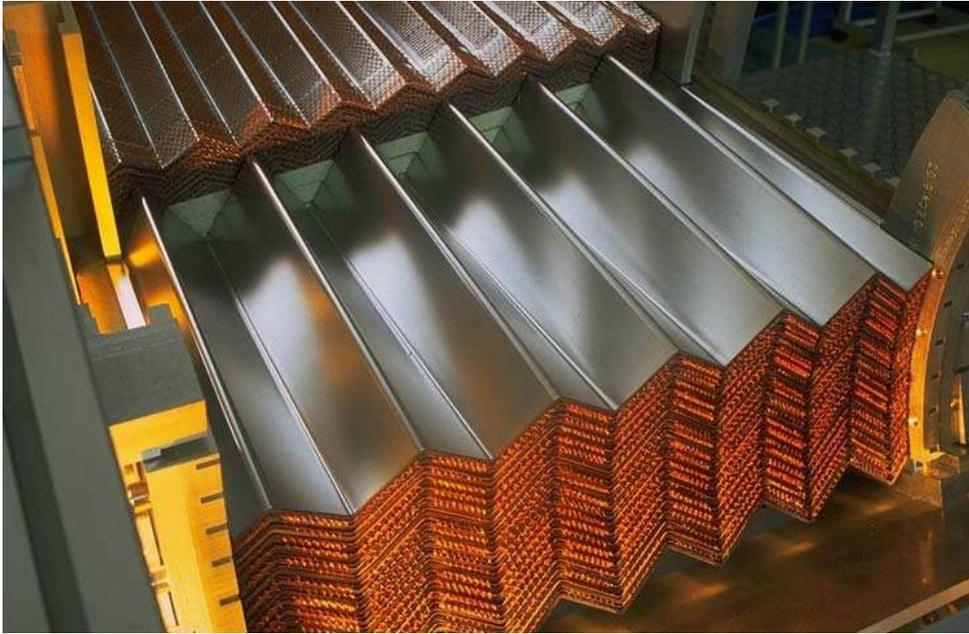
FIGURE 3.7 – Géométrie en accordéon de la partie tonneau du calorimètre électromagnétique à argon liquide d'ATLAS.
