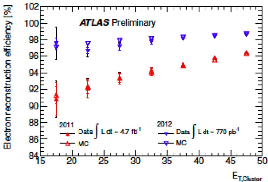
FIGURE 3.12 – Efficacité de reconstruction des électrons en fonction de l'énergie transverse pour les données et les simulations de 2011 (traces par défaut) et 2012 (traces avec GSF).
