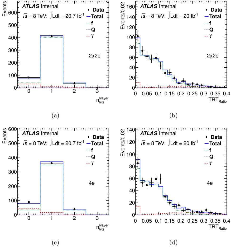
FIGURE 4.9 – Résultat des ajustements de (a)  $n_{\text{BLayer}}$  et (b)  $TRT_{\text{ratio}}$  pour les différentes composantes du bruit de fond dans le canal  $2e2\mu$ . Les mêmes résultats pour le canal  $4e$  sont présentés dans (c) et (d). Les notations des différentes composantes de bruit de fond sont : (f) pour les jets légers ressemblants à un électron, ( $\gamma$ ) pour les conversions de photons, (Q) pour les électrons provenant de la désintégration semi-leptonique d'un quark lourd.
