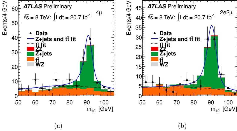
FIGURE 4.1 – Distribution de  $m_{12}$  dans la région de contrôle où les coupures d’isolation ne sont pas appliquées sur les deux muons secondaires et où au moins un des deux muons ne passe pas la coupure sur la signficance du paramètre d’impact. Le cas  $4\mu$  est représenté en (a) et le cas  $2e2\mu$  en (b). Les ajustements utilisés pour  $t\bar{t}$  et  $Z + \text{jets}$  sont présentés, ainsi que les MC attendus pour pouvoir comparer.
