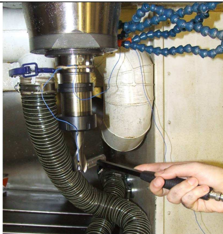
FIGURE 3.2 – Montage utilisé pour le sonnage de la broche.
