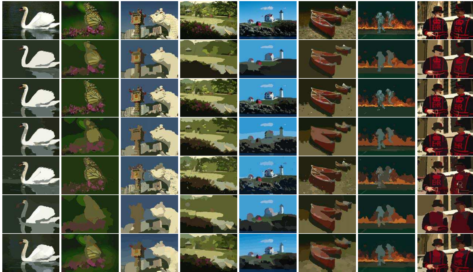
FIGURE 2.22 – Illustration des segmentations sur huit images de la base de BERKELEY [Arbelaez 2011] (de haut en bas : les images originales, images segmentées par CTB, images segmentées par MeanShift, images segmentées par FCR, images segmentées par la méthode de FELZENSZWALB et HUTTENLOCHER, images segmentées par CTM et images segmentées par Jseg).
