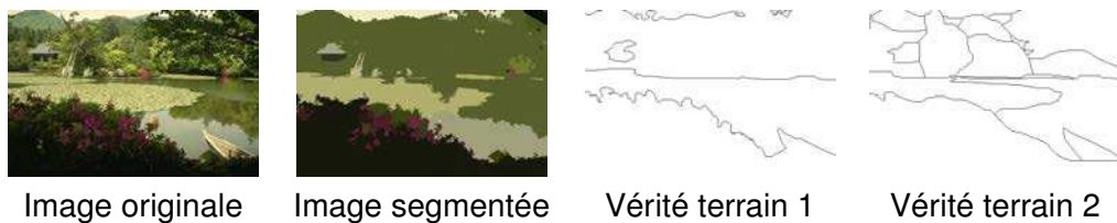
FIGURE 2.7 – Segmentation automatique par l'algorithme MeanShift et deux segmentations manuelles, d'une image de la base de BERKELEY.
