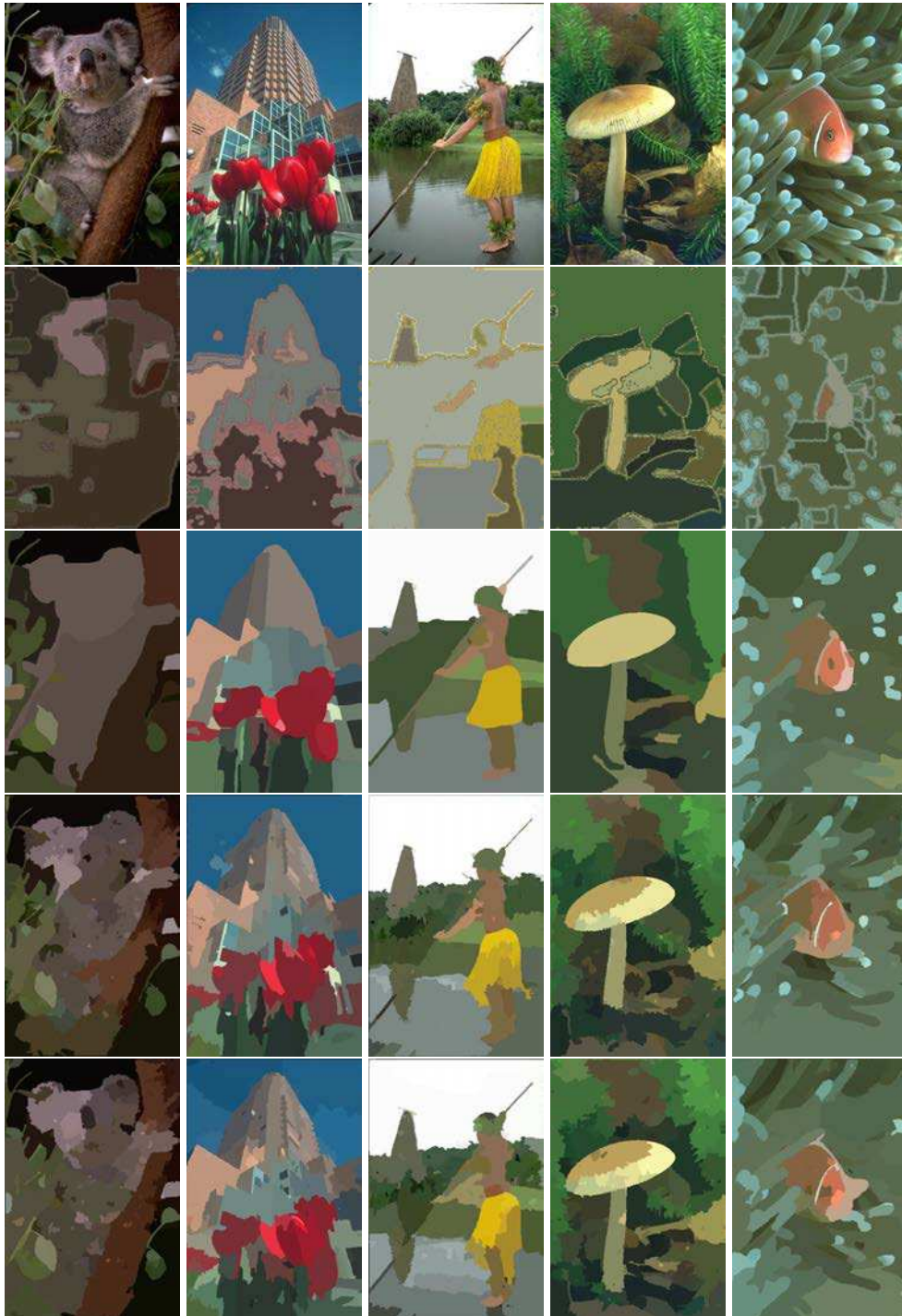
FIGURE 1.22 – Résultats des principales méthodes de segmentation sur une sélection d'images de la base de BERKLEY [Berkeley] (de haut en bas : images originales, méthode de segmentation proposée par CHAN et VESE [Chan 2001], méthode de segmentation par combinaison couleur, texture et luminance [Arbelaez 2011], méthode de segmentation par combinaison couleur/texture fixe [Angulo 2007] et méthode de segmentation par combinaison couleur/texture adaptative [Cohen 2009]).
