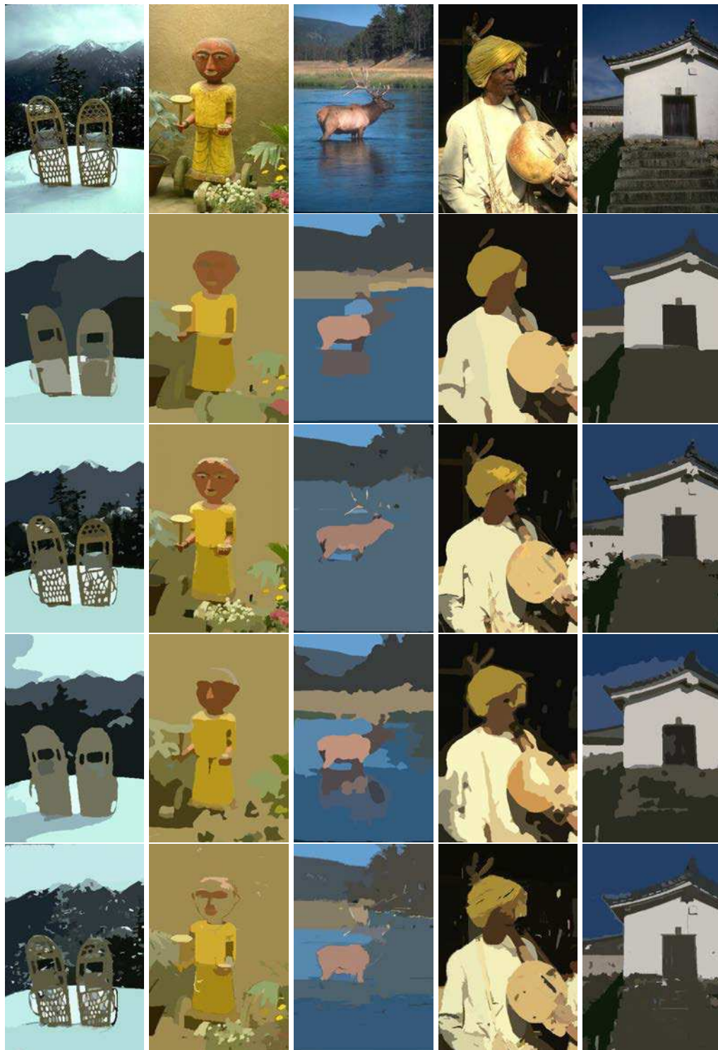
FIGURE 3.15 – Illustration des résultats de segmentation sur cinq images de la base de BERKELEY (de haut en bas : les images originales, les images segmentées par CTB, les images segmentées par MeanShift, les images segmentées par FCR et les images segmentées par la méthode de FELZENSZWALB et HUTTENLOCHER).
