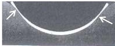
Figure I.7 Film liquide séparant une sphère solide et une interface liquide/liquide : présence d'un minimum d'épaisseur en périphérie. <sup>(43)</sup>
