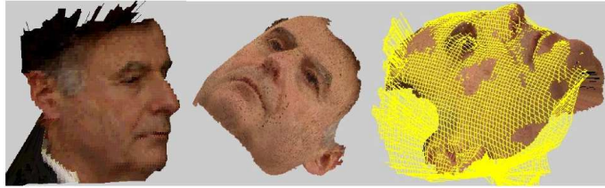
FIGURE 1.13 – À droite, un exemple de recalage ICP, extrait de [Lu et al. 2004]. Le visage de référence (au milieu) est représenté avec sa texture, le visage recalé (à gauche) est représenté via son maillage, en jaune sur l'image de droite.
