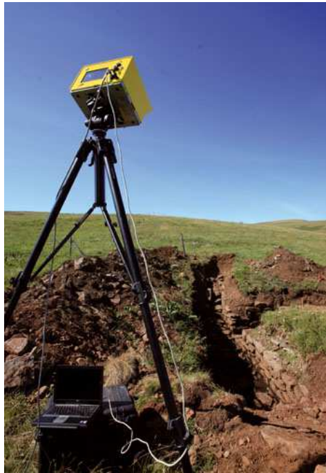
FIGURE 1.1 – Capture de la topologie d'un terrain sur un lieu de fouilles archéologiques par un scanner 3D à balayage laser.
