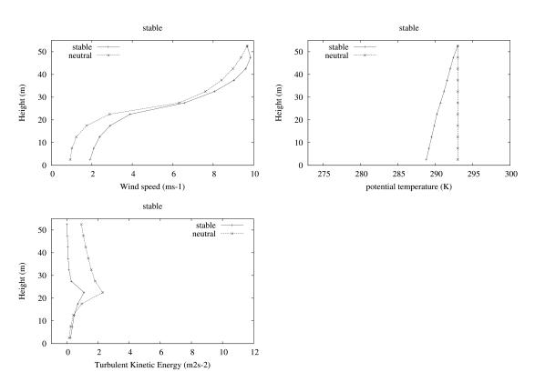
Figure 7.8: Comparaison du profil de vent (en  $ms^{-1}$ ), de la température potentielle (en K) et de l'énergie cinétique turbulente (en  $m^2s^{-2}$ ) issues de CIM avec des obstacles dans des conditions stable et neutre. L'altitude est en mètre.
