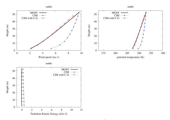
Figure 7.6: Comparaison du profil de vent (en  $ms^{-1}$ ), de la température potentielle (en K) et de l'énergie cinétique turbulente (en  $m^2s^{-2}$ ) obtenu avec la MOST au dessus d'une surface plane et avec CIM (avec et sans la correction  $C_G$  dans la T.K.E.) dans des conditions stable. L'altitude est en mètre.
