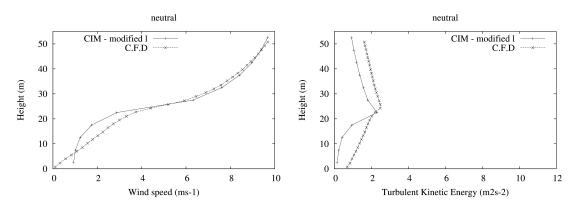
Figure 7.5: Comparaison du profil de vent (en  $ms^{-1}$ ) et de l'énergie cinétique turbulente (en  $m^2s^{-2}$ ) avec des obstacles à partir de CIM et du C.F.D. L'altitude est en mètre.
