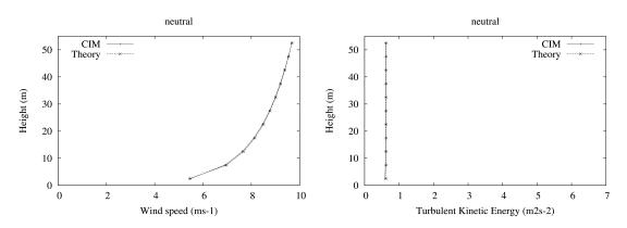
Figure 7.4: Comparaison du profil de vent (en  $ms^{-1}$ ) et de l'énergie cinétique turbulente (en  $m^2s^{-2}$ ) calculées à partir de la solution analytique issue de la théorie de la surface de Prandtl et de CIM. L'altitude est en mètre.
