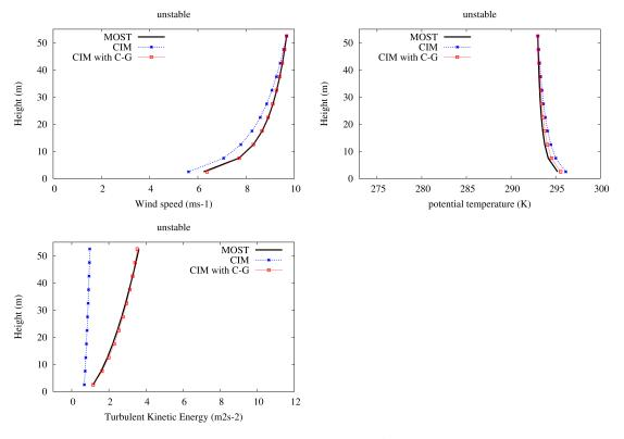
Figure 7.7: Comparaison du profil de vent (en  $ms^{-1}$ ), de la température potentielle (en K) et de l'énergie cinétique turbulente (en  $m^2s^{-2}$ ) obtenu avec la MOST au dessus d'une surface plane et avec CIM (avec et sans la correction  $C_G$  dans la T.K.E.) dans des conditions instable. L'altitude est en mètre.
