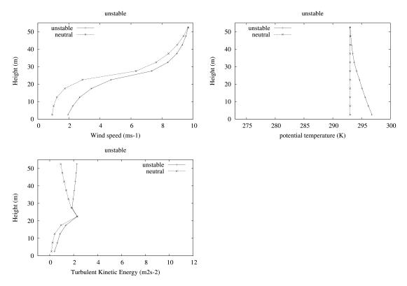
Figure 7.9: Comparaison du profil de vent (en  $ms^{-1}$ ), de la température potentielle (en K) et de l'énergie cinétique turbulente (en  $m^2s^{-2}$ ) issues de CIM avec des obstacles dans des conditions instable et neutre. L'altitude est en mètre.
