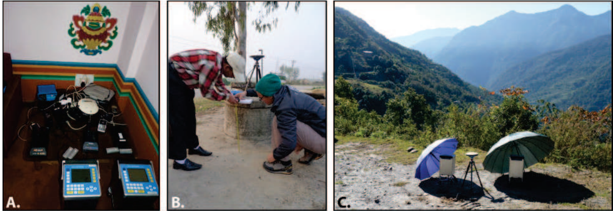
FIGURE 2.3 Instruments utilisés et méthodologie d'acquisition lors des campagnes gravimétriques. (A) Photographie de l'ensemble du matériel utilisé lors des missions de terrain. (B) Estimation de la hauteur de l'antenne GPS par rapport au gravimètre. (C) Point de mesure gravimétrique au Bhoutan. Les parapluies permettent de protéger les gravimètres d'une exposition directe aux rayons solaires.
