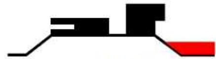
02_une plate-forme haute [les nouvelles activités sont à l'abri d'une crue maximale]
