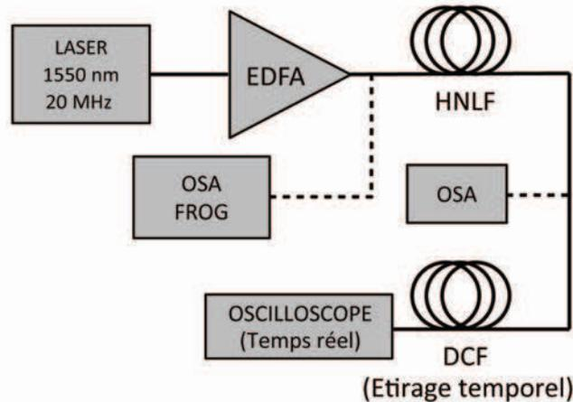
FIGURE 5.1 – *Dispositif expérimental utilisé pour la caractérisation du bruit du supercontinuum. EDFA : Amplificateur fibré dopé Erbium ; HNLf : Fibre hautement non-linéaire ; DCF : Fibre à compensation de dispersion ; OSA : Analyseur de spectre optique ; FROG : Autocorrélateur optique résolu en fréquence.*
