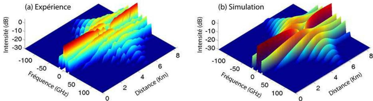
FIGURE 4.9 – *Dynamiques spectrales en fonction de la distance de propagation de d'instabilité de modulation induite expérimentalement (a) et comparées avec celles des prédictions issues de simulations numériques de l'ESNL généralisée (b). La phase de croissance de l'instabilité jusqu'au point de compression maximale est clairement visible jusqu'à 5 km, suivi d'un retour de l'énergie des bandes de modulations vers la pompe au-delà de ce point.*
