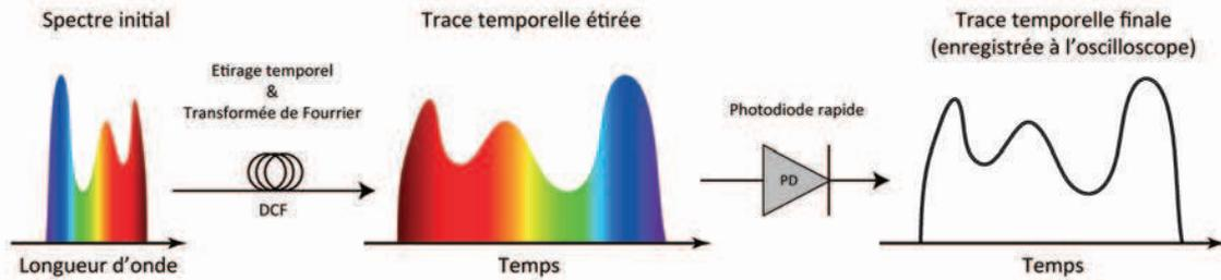
FIGURE 5.2 – *Principe schématique d'étirage temporel du spectre optique. Les fluctuations du spectre initial sont résolues en temps réel par un système opto-électronique de détection ultra-rapide (photodiode + oscilloscope).*
