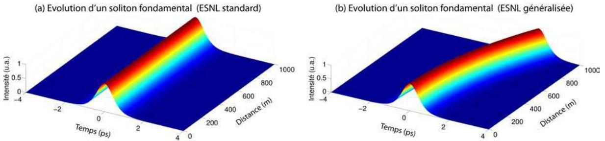
FIGURE 1.11 – Soliton fondamental ( $N=1$ ) de durée  $T_{FWHM} = 1$  ps évoluant dans un 1 km de SMF standard en considérant l'ESNL standard (a) et l'ESNL généralisée (b). Paramètres :  $T_{FWHM} = 1$  ps ;  $P_0 = 52.1$  W ;  $\beta_2 = -21.8$  ps<sup>2</sup> km<sup>-1</sup> ;  $\beta_3 = 1.20 \times 10^{-2}$  ps<sup>3</sup> km<sup>-1</sup> ;  $\gamma_{NL} = 1.3$  W<sup>-1</sup> km<sup>-1</sup> ;  $\lambda_0 = 1550$  nm
