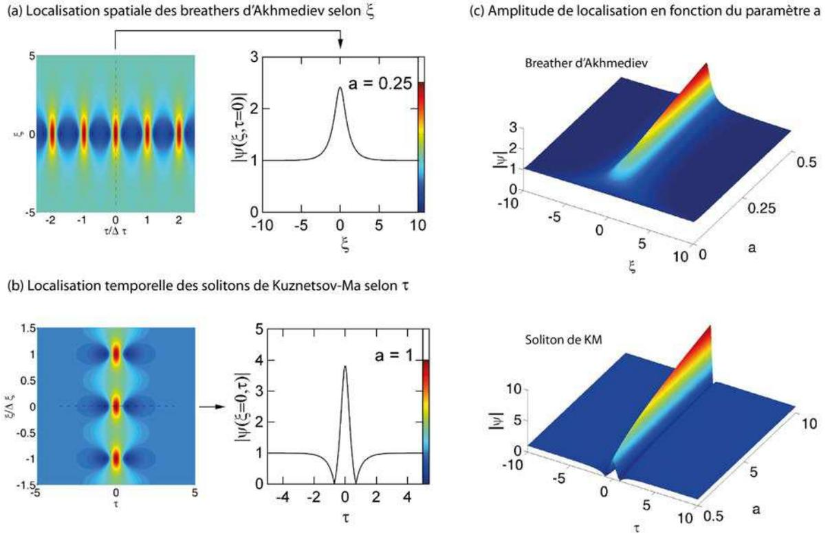
FIGURE 4.13 – Comparaison de la localisation des SFC dans le cas des breathers d'Akhmediev avec  $a = 0.25$  (a) et des solitons de KM pour  $a = 1$  (b). La dimension de localisation dont sont extraits les profils de  $|\psi(\xi, \tau)|$  sont représentés en traits pointillés. (c) Profils de localisation maximale des SFC en fonction du paramètre de fréquence normalisée  $a$ .
