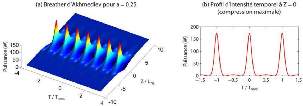
FIGURE 4.2 – Simulations numériques de la solution analytique du breather d'Akhmediev obtenue pour  $P_0 = 30$  W et  $a = 0.25$ . (a) Évolution longitudinale du breather d'Akhmediev prédite par l'Eq. (4.5). (b) Profil temporel d'intensité à  $z' = 0$  (compression temporelle maximale) donné par l'Eq. (4.7)
