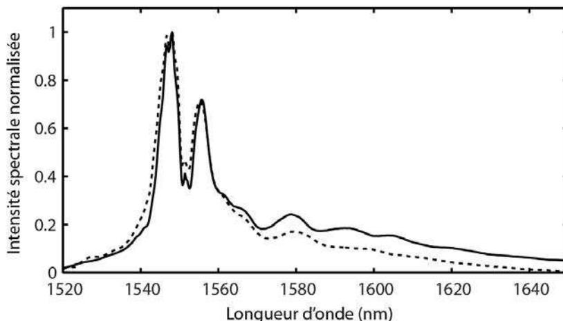
FIGURE 5.3 – *Comparaison du spectre en échelle linéaire après 20 m de propagation obtenu par l'analyseur de spectre optique (ligne continue) et reconstitué après post-traitement par étirage spectral dispersif (ligne pointillée).*
