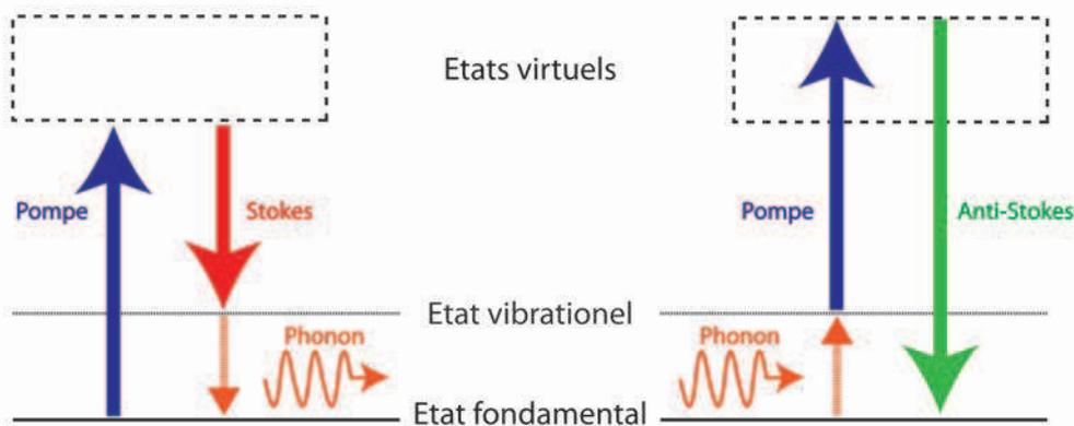
FIGURE 1.9 – Diagramme d'excitation de la diffusion Raman.
