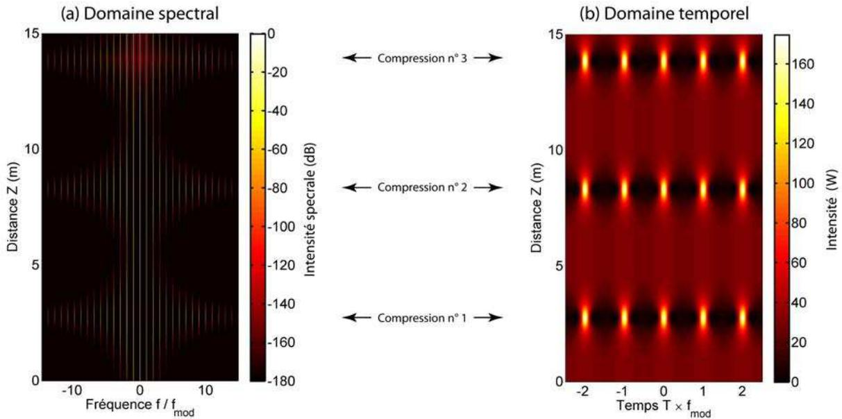
FIGURE 4.19 – Évolutions spectrale (a) et temporelle (b) d'une onde continue de puissance  $P_0 = 30$  W faiblement modulée ( $a_{mod} = 0.01$ ) au maximum de gain de l'instabilité de modulation ( $a = 0.25$ ). L'excitation d'un breather d'Akhmediev non idéal mène à un phénomène de compressions spatiales périodiques plutôt qu'à une récurrence parfaite de l'instabilité. Résultats issus de simulations numériques prenant en compte l'ESNL standard.
