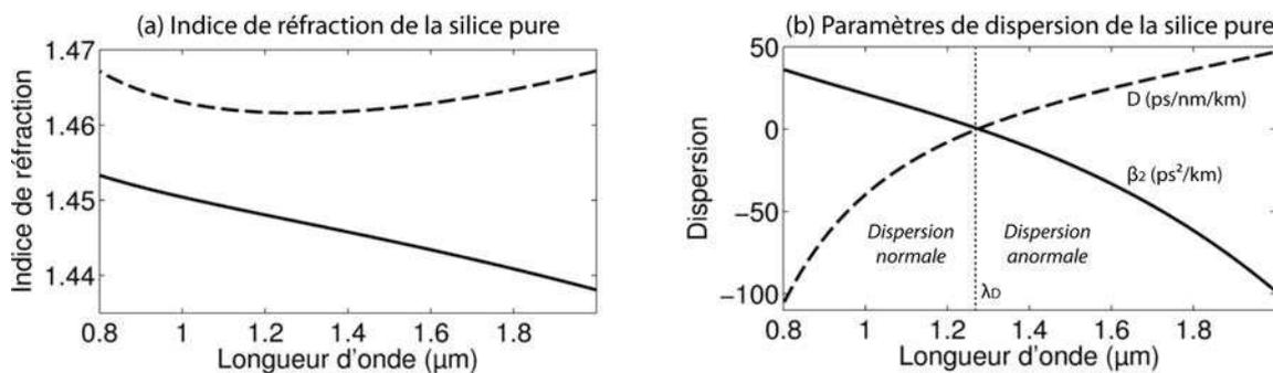
FIGURE 1.4 – (a) Courbe de variation d'indice optique  $n$  (ligne continue) et d'indice de groupe  $n_g$  (trait pointillé) de la silice. (b) Dispersion de la vitesse de groupe  $\beta_2$  et paramètre de dispersion  $D$  correspondant.
