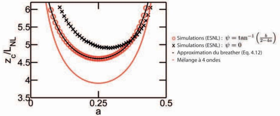
FIGURE 4.4 – Cas d'une onde continue modulée : Distances de compression maximale en fonction de la fréquence de modulation  $a$  prédites analytiquement à partir de Eq. (4.12) (ligne noire) et comparées aux simulations numériques avec  $\psi = \tan^{-1}(b/(2 - 4a))$  (cercles rouge) et  $\psi = 0$  (croix noires) ainsi qu'au modèle perturbatif du mélange à quatre ondes dégénéré (ligne rouge) [98, 99].
