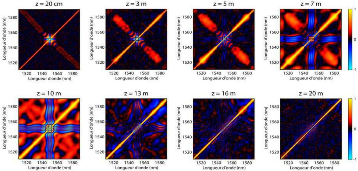
FIGURE 5.9 – Résultats de simulations numériques présentant l'évolution de la carte de corrélation d'intensité spectrale  $\rho(\lambda_1, \lambda_2)$  en fonction de la distance de propagation. L'échelle des couleurs est donnée sur la partie droite telle que les corrélations positives soient présentées en jaune, les corrélations négatives en bleu et le noir représente une absence de corrélation. Les cartes sont ici centrées sur la longueur d'onde de la pompe (1550.6 nm).
