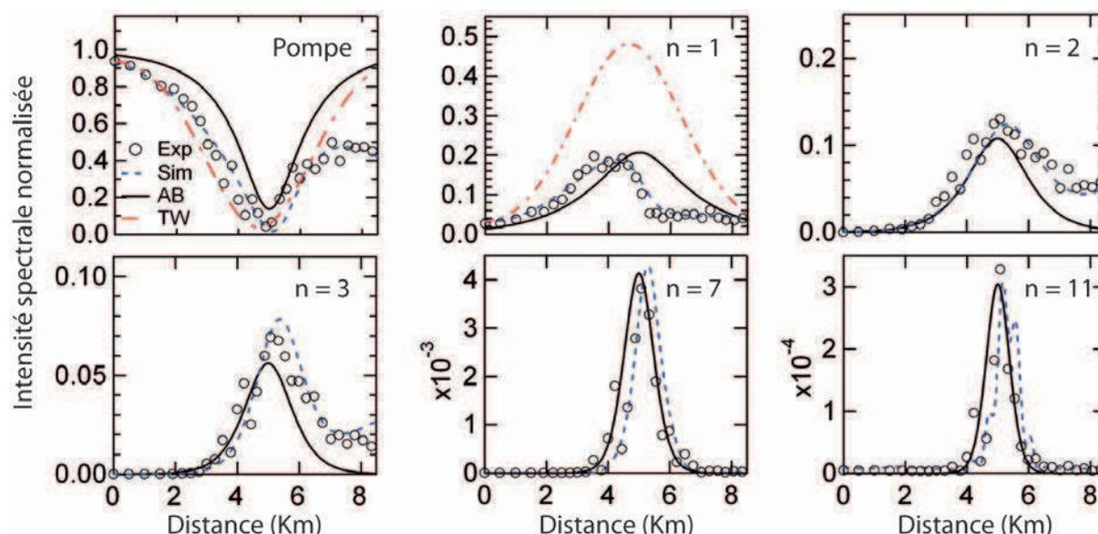
FIGURE 4.10 – Évolution longitudinale des intensités spectrales normalisées de la pompe et des bandes de modulation d'ordre  $n = 1, 2, 3, 7, 11$  obtenues expérimentalement (cercles), numériquement (ligne bleue pointillée) et comparées à la théorie des breathers (ligne noire continue) ainsi qu'à la théorie du mélange à quatre ondes dégénéré (ligne rouge pointillée, noté TW - Truncated Wave) [96, 246].
