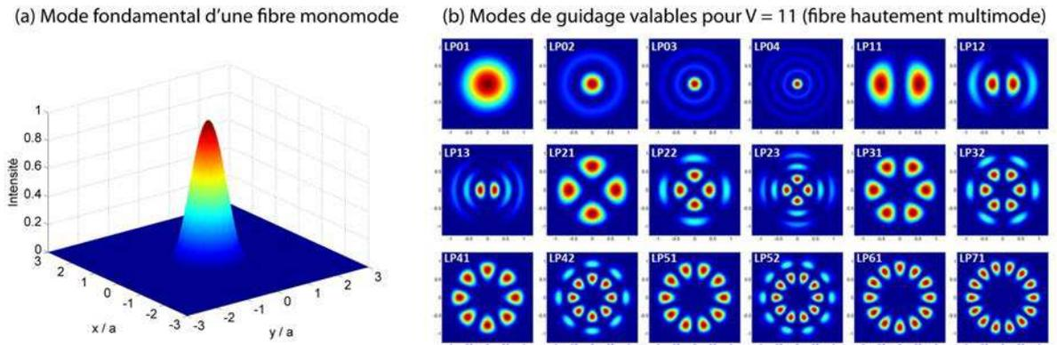
FIGURE 1.2 – Profils spatiaux de guidages dans une fibre. (a) Mode de guidage fondamental (LP<sub>01</sub>) obtenu dans une fibre purement monomode. (b) Modes de guidages d'ordres supérieurs obtenus dans une fibre possédant un paramètre de fréquence normalisée  $V = 11$  (fibre hautement multimode)
