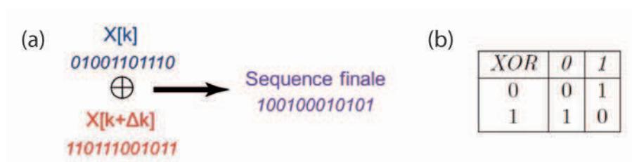
FIGURE 3.11 – (a) Principe de suppression du biais statistique par une porte OU Exclusif ( $XOR$ ) appliquée avec une copie de la séquence auto-retardée. (b) Table de vérité de la fonction logique  $XOR$ .
