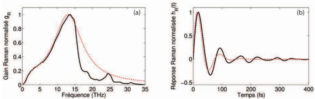
FIGURE 1.10 – Spectre de gain Raman  $g_R(\Omega_R)$  obtenu à  $\lambda_0 = 1 \mu\text{m}$  pour des ondes pompe et Stokes copolarisées (a) et réponse temporelle Raman normalisée (b) calculés à partir de l'Eq. (1.50) (ligne pointillée) et comparés aux mesures expérimentales issues de [45] (ligne continue).
