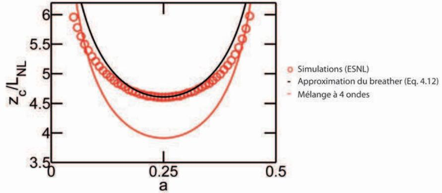
FIGURE 4.5 – Cas d'une onde continue modulée à partir d'une seule bande latérale de modulation : Distances de compression maximale en fonction de la fréquence de modulation  $a$  prédites analytiquement à partir de Eq. (4.12) (ligne noire) et comparées aux simulations numériques (cercles rouge) ainsi qu'au modèle perturbatif du mélange à quatre ondes dégénéré (ligne rouge) [98, 99].
