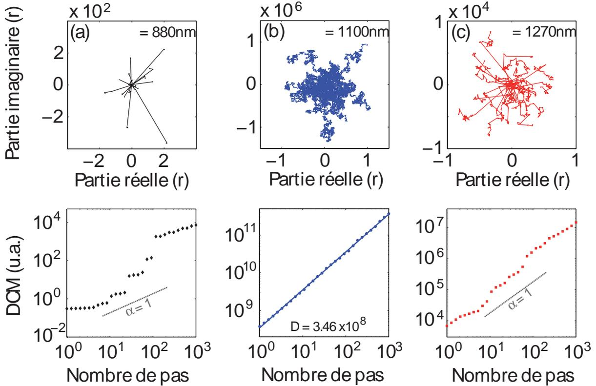
FIGURE 3.8 – (Haut) Représentation de 20 marches aléatoires de 1000 pas unitaires dont la direction  $\varphi_k$  et la longueur  $|\mathbf{r}_k|$  de chaque pas sont respectivement obtenues à partir des fluctuations de phase et d'intensité extraites à 880 nm (a), 1100 nm (b) et 1270 nm (c). (Bas) Déplacements carré moyen équivalents calculés en fonction du nombre de pas  $n$  pour un ensemble de 200 marches aléatoires aux longueurs d'onde correspondantes.
