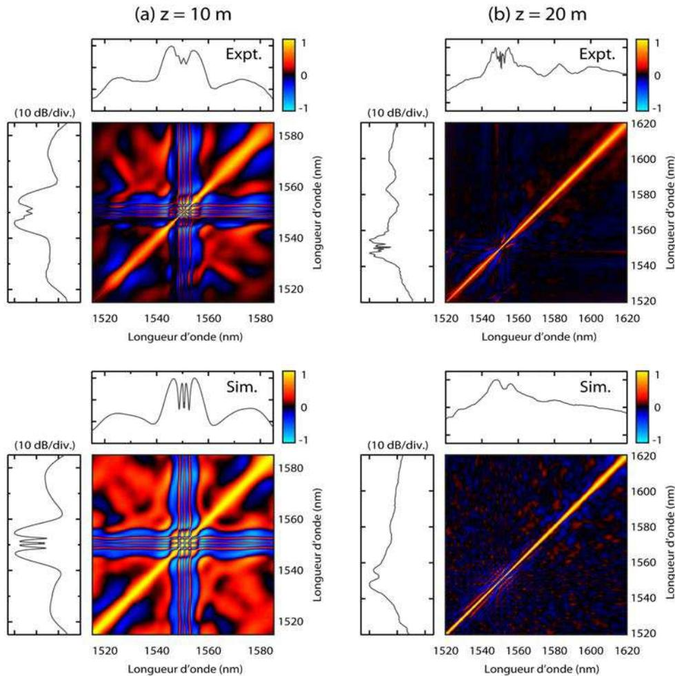
FIGURE 5.10 – Pour des distances de propagation de 10 m (a) et 20 m (b) dans la fibre, on compare les cartes de corrélations spectrales  $\rho(\lambda_1, \lambda_2)$  obtenues expérimentalement (haut) et numériquement (bas). Afin d'aider à l'interprétation visuelle, les spectres moyens respectifs sont projetés sur les axes des cartes de corrélations.
