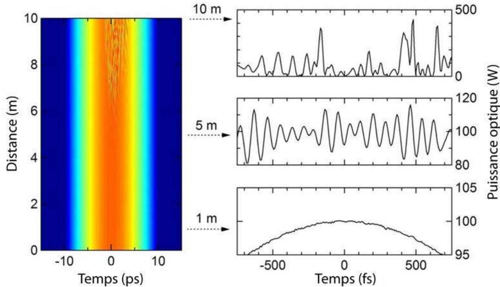
FIGURE 4.20 – *Simulation numérique montrant l'évolution longitudinale temporelle d'une impulsion ps dans la phase d'émergence d'un supercontinuum incohérent. (Droite) Profils temporels extraits aux distances clés de l'évolution de l'impulsion. Figure adaptée de Ref. [149] utilisant l'ESNL généralisée.*
