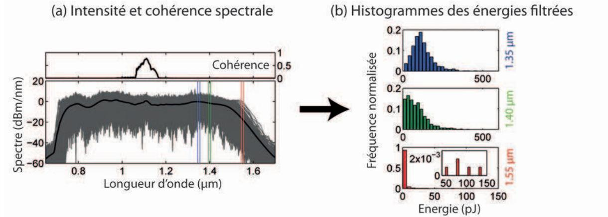
FIGURE 3.1 – (a) Intensités spectrales obtenues pour 1000 réalisations (lignes grises) et spectre moyen (ligne noire) montrant de larges fluctuations dans le supercontinuum obtenu après 50 cm de propagation. La partie supérieure montre la cohérence spectrale du premier ordre du SC calculée à partir de l'Eq. (2.8). (b) Histogrammes de la distribution des énergies obtenus par filtrage spectral considérant un filtre de largeur  $\Delta\lambda = 10$  nm pour les 3 longueurs d'onde étudiées.
