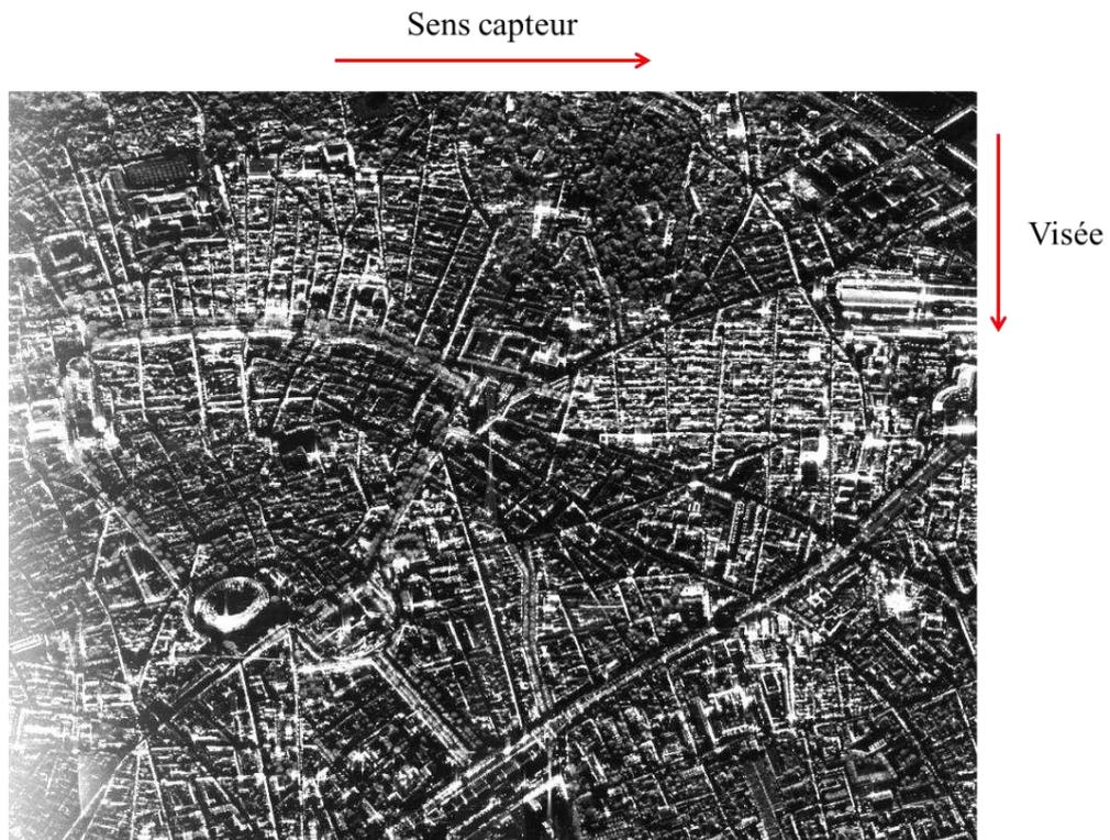
*Figure 3.3 - Exemple d'une image THR non géoréférencée acquise par le capteur SETHI à partir d'une trajectoire circulaire aéroportée autour des arènes de Nîmes. L'image représente une zone d'environ 2km par 2km.*
