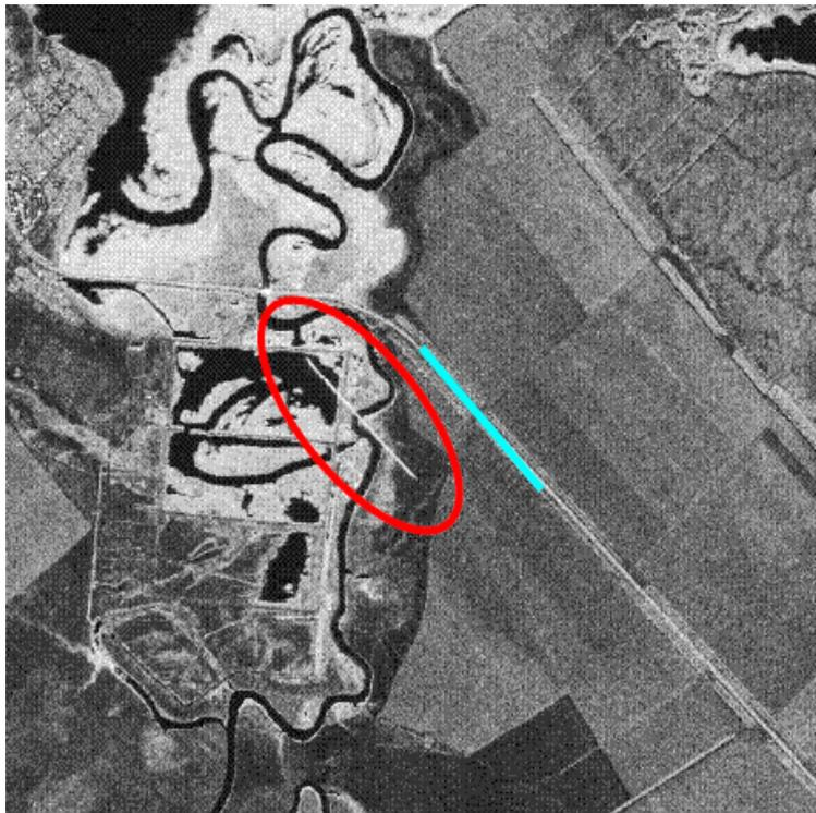
*Figure 2.3 - Image prise par le capteur TERRASAR-X en Russie où l'on peut observer un rail de chemin de fer (cyan) et la signature d'un train qui apparaît à côté du rail (entourée en rouge). Cette délocalisation est un marqueur de la vitesse radiale d'une cible mobile en RSO.*
