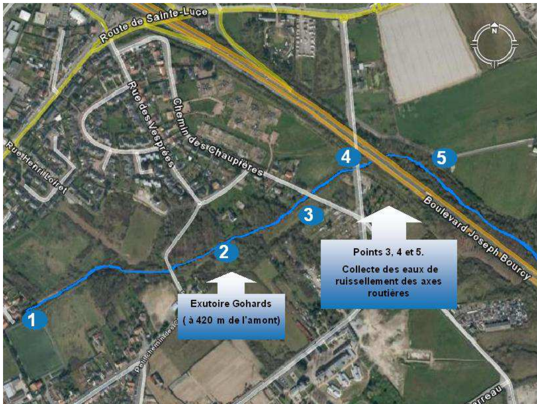
FIGURE 2.4 – Points d'arrivée des eaux de ruissellement au ruisseau des Gohards
