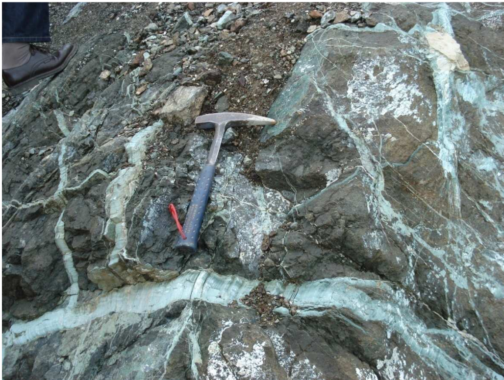
Figure 2.8 : Harzburgite recoupée par des veines de chrysotile, proche de l'ancienne mine d'Asbestos.
