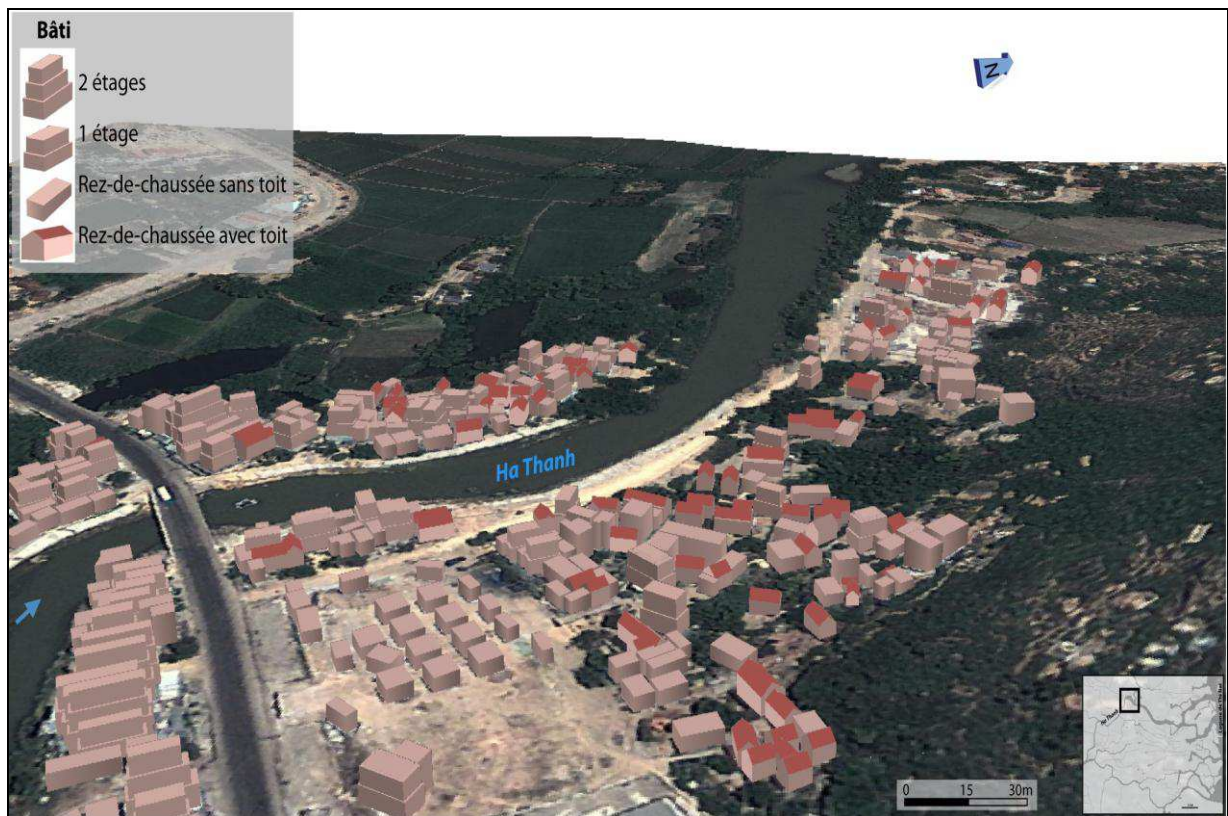
Figure 8.25. Exemple d'une modélisation 3D du bâti de la zone inondable (Ngo, 2013)
