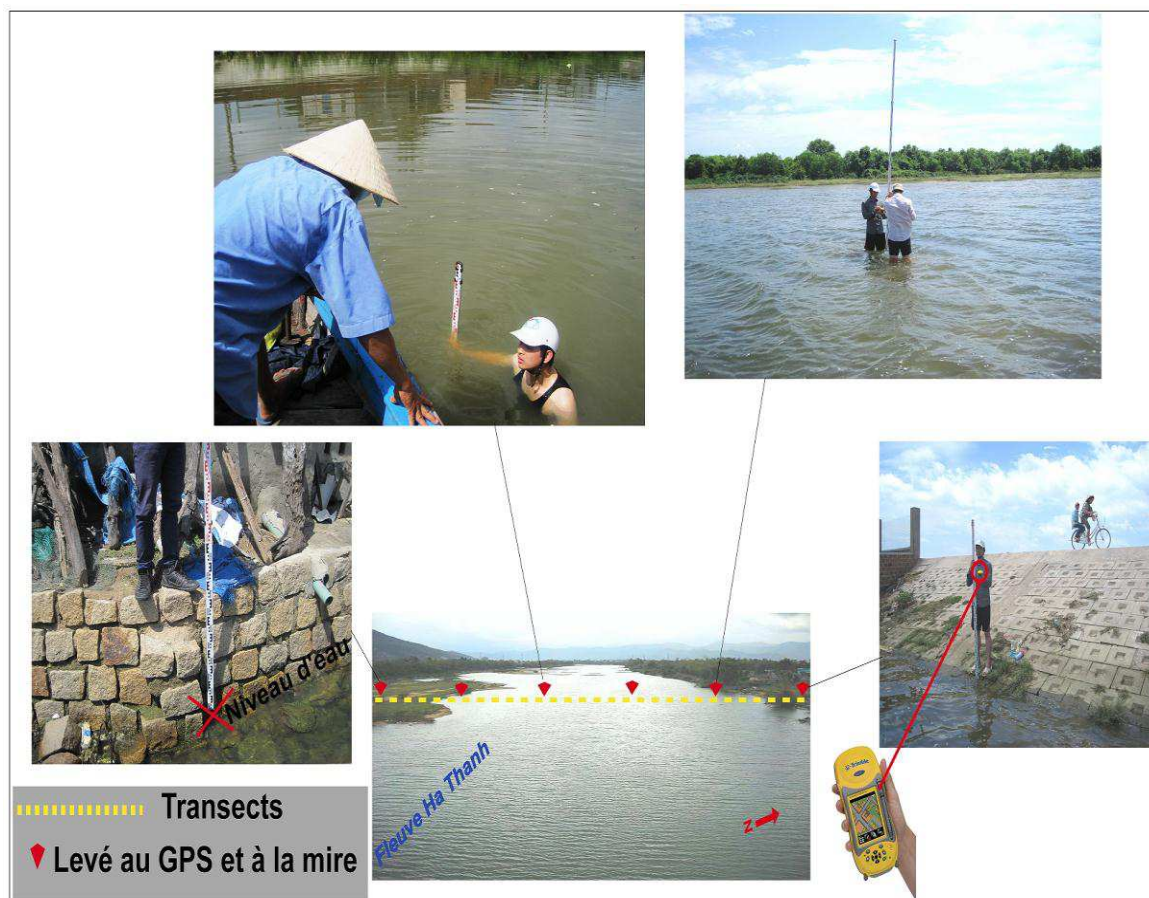
Figure 3.18. Méthode de levés topographiques dans le lit mineur du fleuve Ha Thanh (Ngo, 2012)
