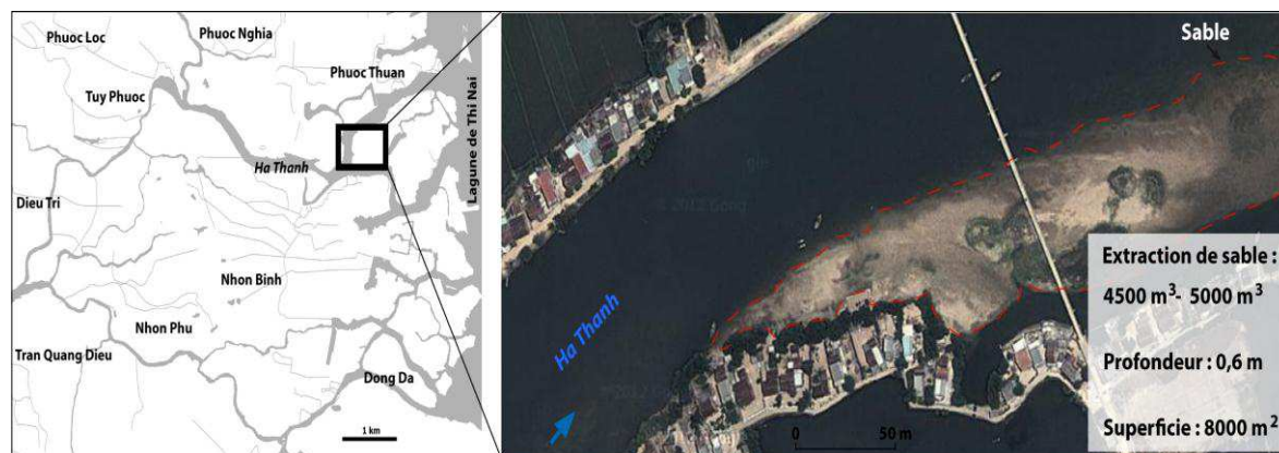
Figure 4.35. Exemple d'extraction de sable au hameau de Diem Van du village de Phuoc Thuan en aval du fleuve Ha Thanh en 2013 (Source de donnée : http://www.baobinhdinh.com.vn , 2013. Réalisation : Ngo, 2013)
