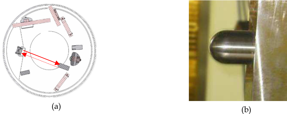
Figure 5-15 : (a) Position des cibles et du transducteur lors des mesures sur CD ; (b) photo de la cible CD.
