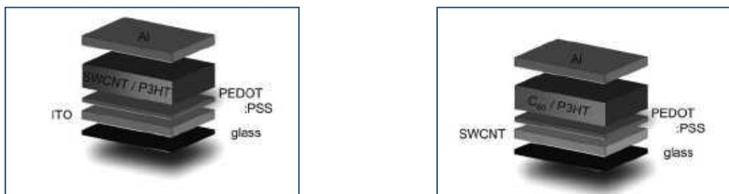
Figure 5-14 : Prototypes d’OPVCs à base de NTC : à gauche SWNT utilisé comme électrode dans les OPVC ayant comme électrode verre/ITO/ PEDOT : PSS/SWNT : P3HT/Al. A droite CNT utilisé comme électrode semi-transparente dans la configuration verre/SWNT/ PEDOT : PSS/P3HT : PCBM/ Al d’après Sgoba et Guldi<sup>221</sup>
