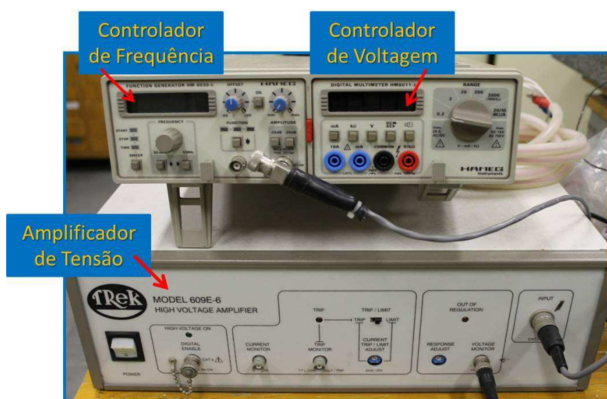
Figura 48: Sistema de amplificador, gerador de função e multímetro para gerar campo elétrico de corrente alternada
