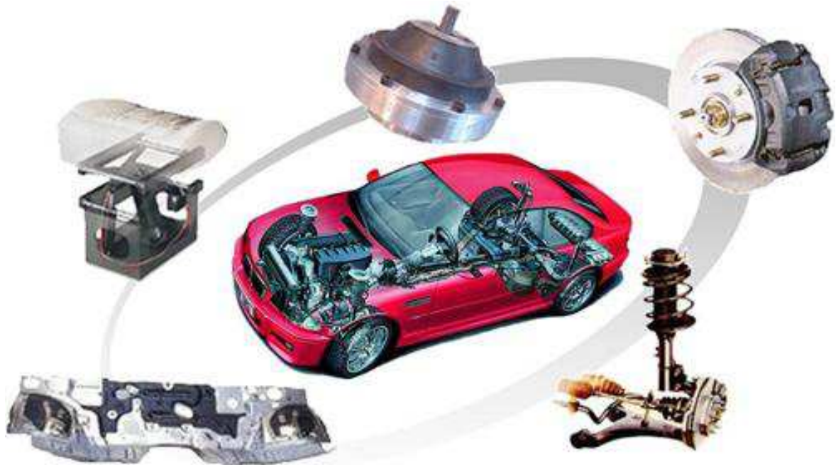
Figura 8: Aplicações de fluidos ER em partes de automóveis (Ssslab, 2010)
