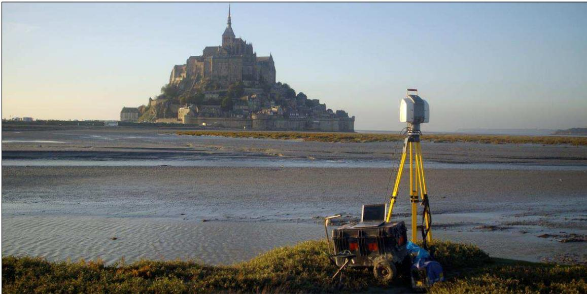
**Figure 3.3: La ScanStation 2 sur le terrain**
