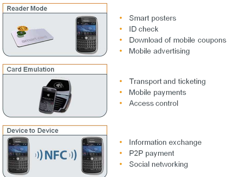
FIGURE 2.5 – Modes de fonctionnement du NFC (source : INSIDE Secure)
