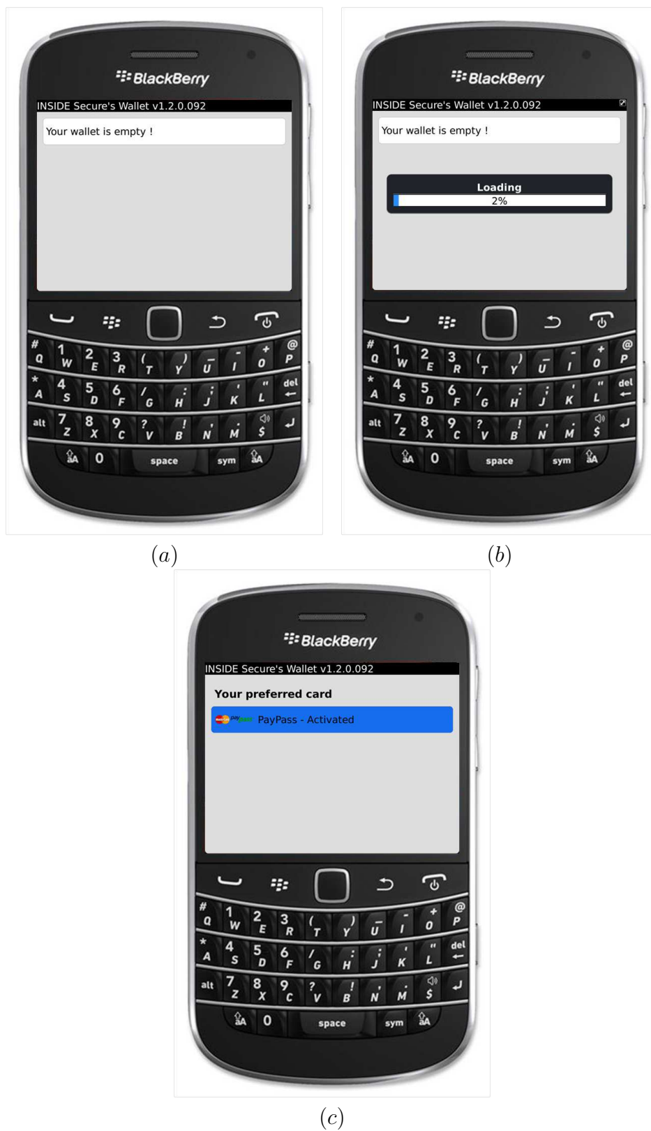
FIGURE 3.19 – Étapes de la validation sur un équipement réel : (a) « réveil » du Wallet, (b) réception du script de déploiement, (c) instantiation du service mobile et de la carte virtuelle correspondante
