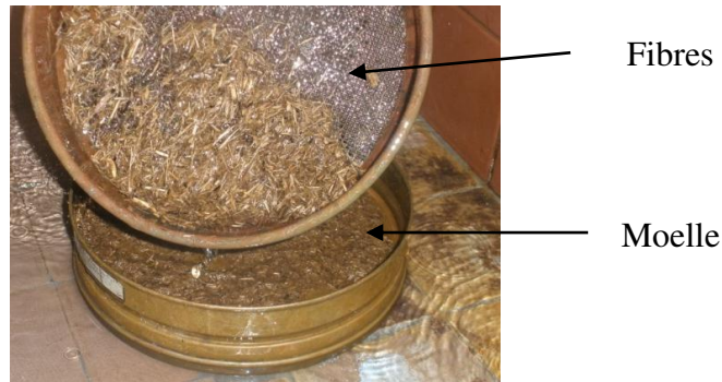
Figure 22. Séparation en humide de la portion fibre/moelle
