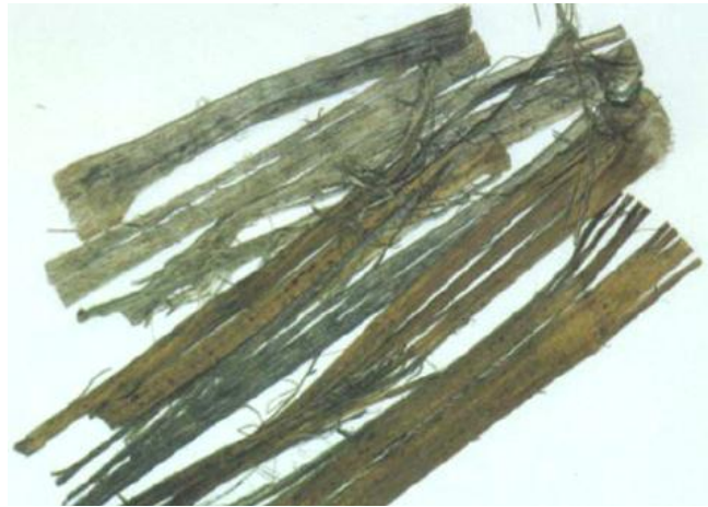
Figure 18. Ecorce de canne obtenue en sortie du système Tilby (Chiparus, 2004)
