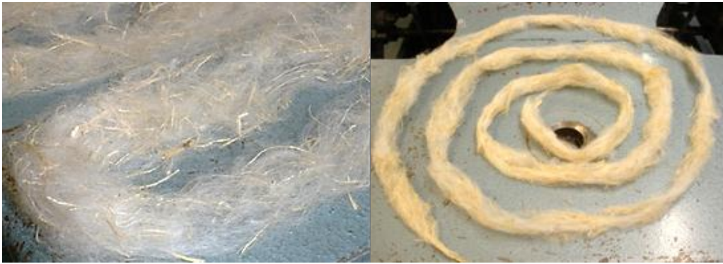
Figure 52. Passage au banc d'étirage: ruban coton-bagasse (30-70)
