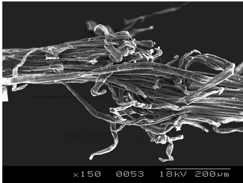
Figure 43. Micrographie électronique d'une fibre présentant un coude dans sa structure
