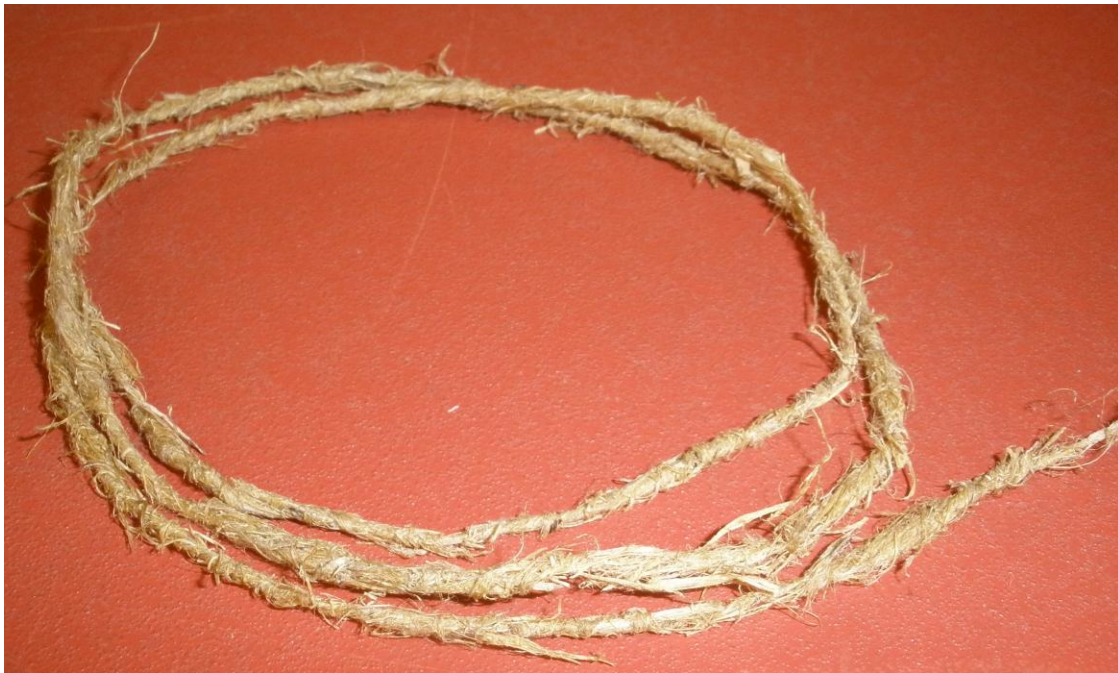
Figure 54. Filage manuel d'un ruban de fibres type BPD-0.1N après cardage
