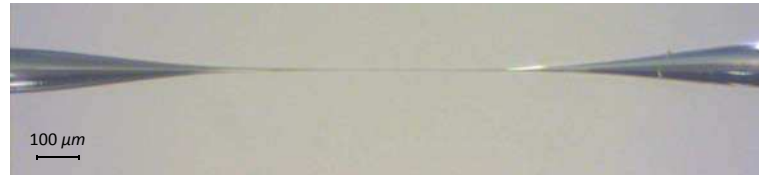
FIGURE 1.8 – Taper bi-conique fabriqué par fusion-étirage à l'aide d'une soudeuse de fibres optiques. La section amincie est inférieure à 2\ \mu\text{m} sur environ 400\ \mu\text{m} de long.
