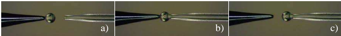
FIGURE 1.6 – Différentes phases de montage d'une sphère sur son support avant manipulation. a) la première étape consiste à saisir une microsphère à l'aide d'une micropipette, b) elle est ensuite alignée puis collée sur une tige en fibre amincie, c) après polymérisation de la colle ultraviolette, nous retirons la micropipette
